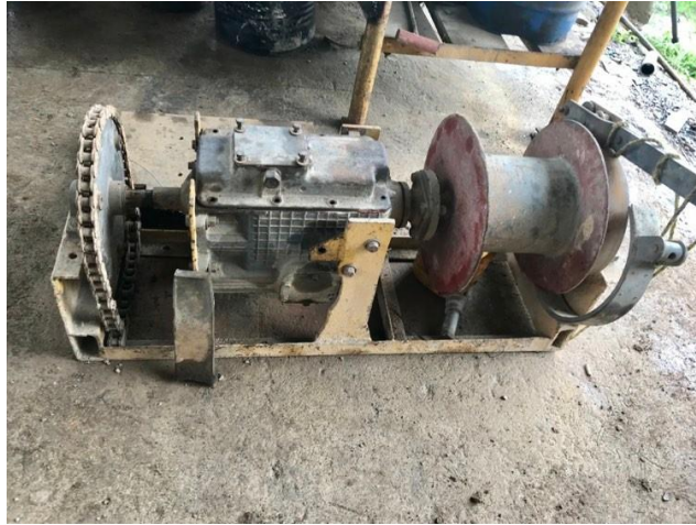
Figura 16-2: Sistema de izaje con plataforma para motor y tambor para enrollado del cable
