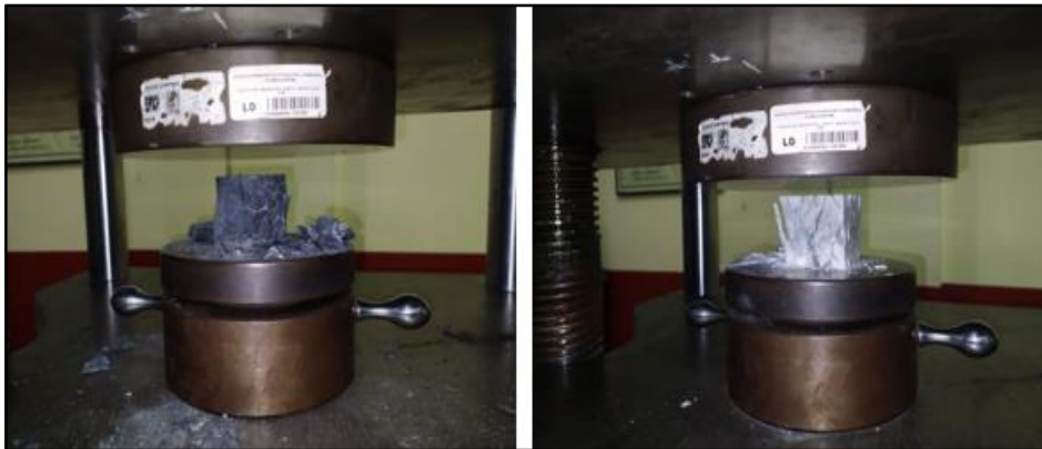
Figura 8-3: Ensayo de compresión uniaxial en roca caja y mineral
