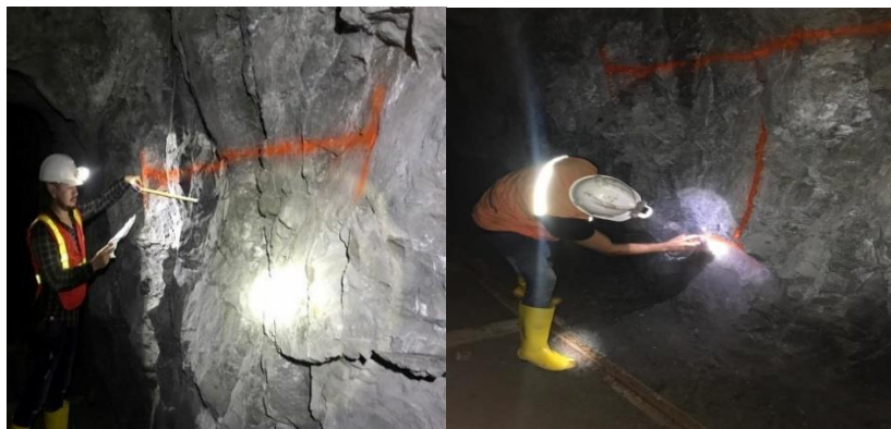
Figura 1-3: Ensayo in situ RQD
