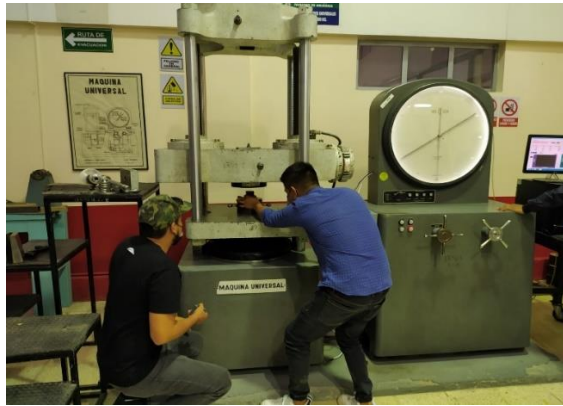
Figura 7-3: Ensayo de compresión uniaxial en máquina universal
