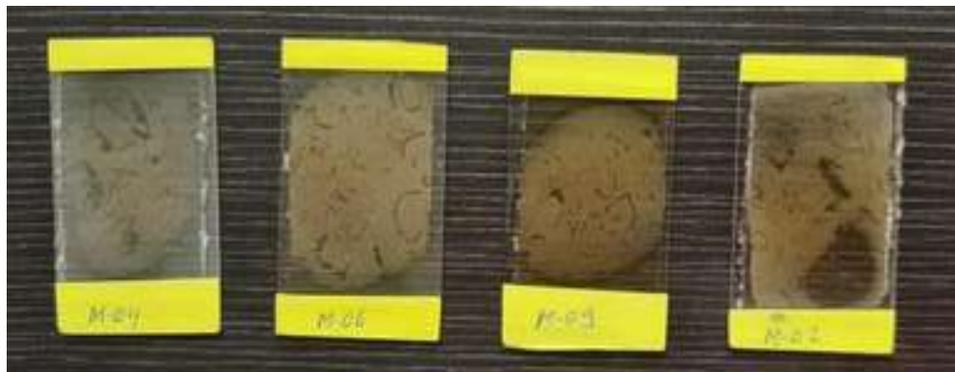
**Figura 2-2.** Láminas delgadas de caliza
