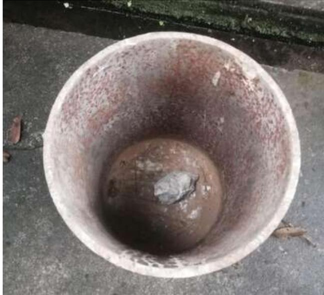
**Figura 7-2.** Conminución de las muestras de caliza
