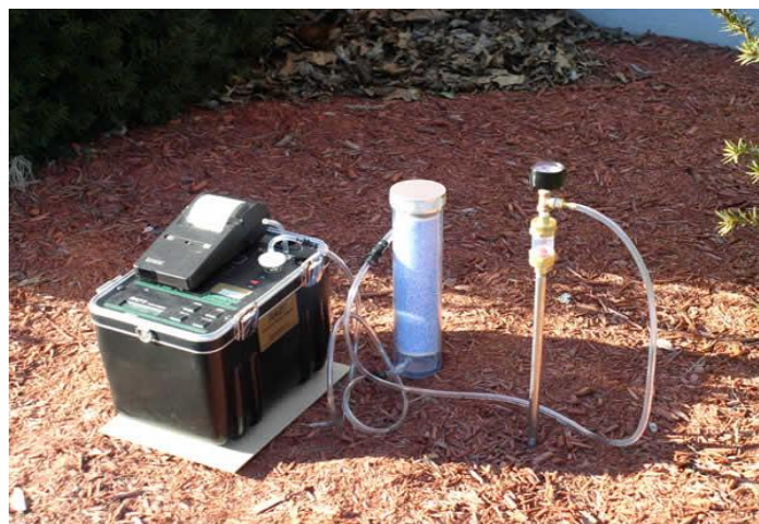
Figura 4-2. Sistema de medición de radón-222 en suelo, usando RAD7.
