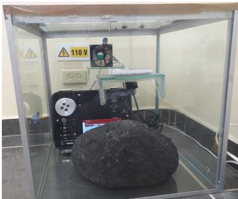
Figura 6-2: Configuración experimental de la técnica de cámara cerrada
