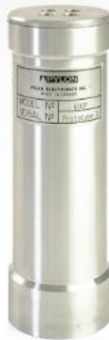
Figura 7-2: Detector de centelleo pasivo celda de Lucas modelo 600P
