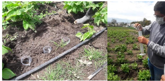
Figura 4-2. Colocación de vasos pluviométricos y medición.
