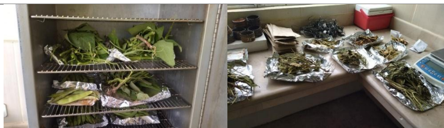
Figura 13-2. Secado en la estufa y peso de la materia seca.
