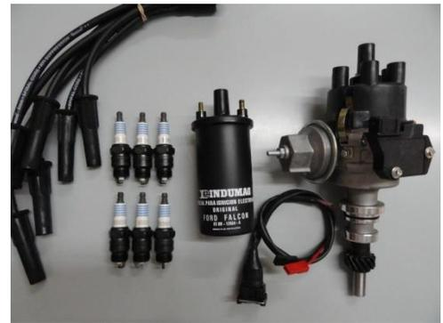
**Figura 3.6-8** Sistema de encendido
