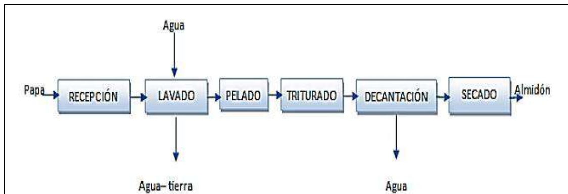
Gráfico 2-1. Diagrama de flujo de la obtención de almidón de papa
