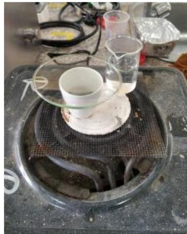
Determinación de % cenizas insolubles en ácido
