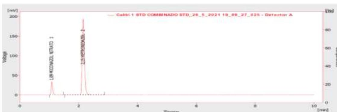
**Gráfico 9-3.** Cromatograma de MTZ y MN a flujo de 1,5 mL/min, temperatura 40 °C, fase móvil (75:25 Buffer: Metanol pH 2,8) a 220 nm
