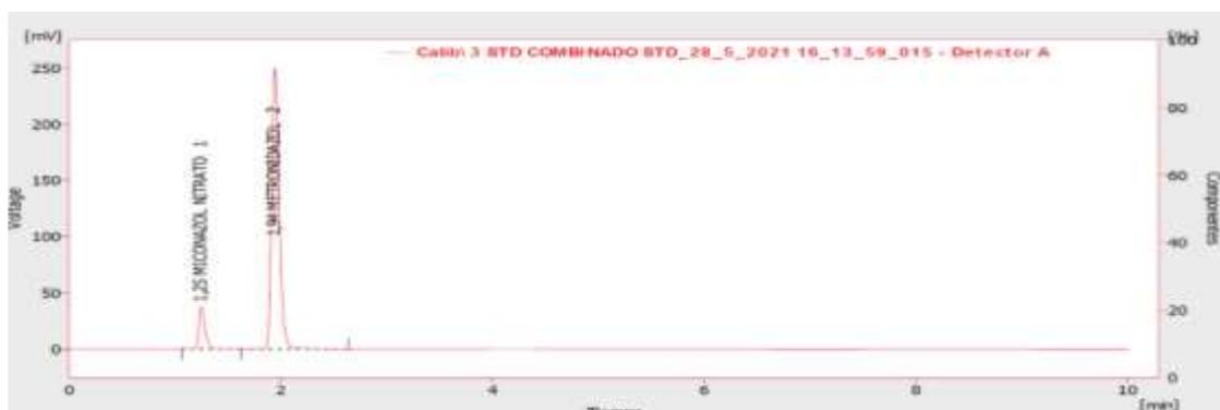
**Gráfico 20-3:** Cromatograma de MTZ y MN a flujo de 1,3 mL/min, temperatura 45 0C, fase móvil (65:35 Buffer: Metanol pH 2,3) a 220 nm
