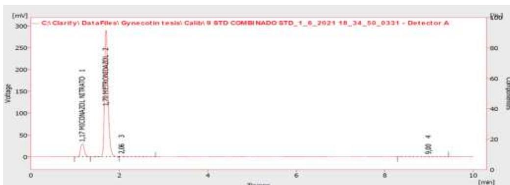
**Gráfico 26-3.** Cromatograma de MTZ y MN a flujo de 1 mL/min, temperatura 40 °C, fase móvil (57:43 Buffer: Metanol pH 2,8) a 220 nm
