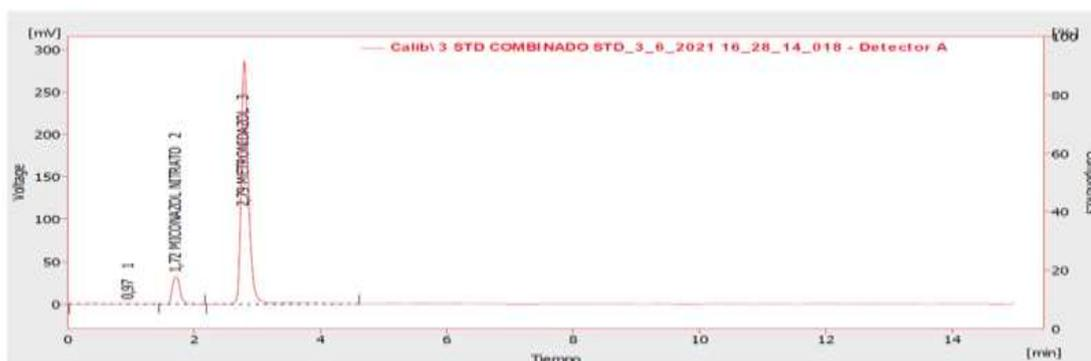
**Gráfico 1-3.** Cromatograma de MTZ y MN a flujo de 0,7 mL/min, temperatura 35 °C, fase móvil (65:35 Buffer: Metanol pH 2,3).
