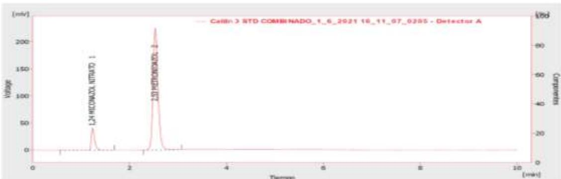
**Gráfico 4-3.** Cromatograma “b” de MTZ y MN a flujo de 1 mL/min, temperatura 40 °C, fase móvil (75:25 Buffer: Metanol pH 2,8) a 220 nm.
