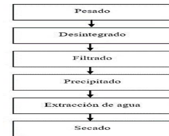
Gráfica 2-1: Diagrama de flujo de obtención de almidón de papa
