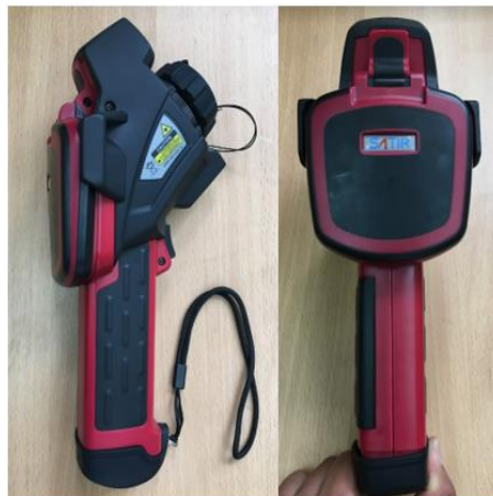
Figura 10-2: Cámara termográfica Satir HotFind VR
