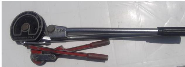
**Figura 16-3:** Dobladora de tubería
