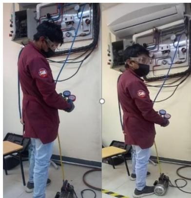
**Figura 41-3:** Proceso de vacío
