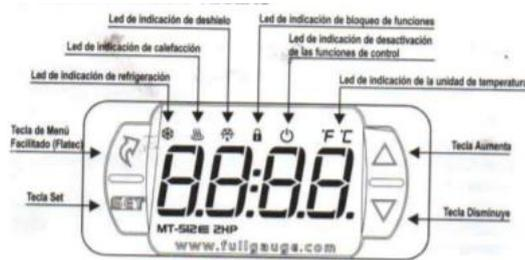
**Figura 39-3:** Indicaciones y teclas del control de temperatura MT-512E
