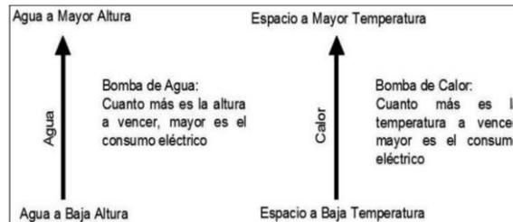
**Figura 3-2:** Analogía de una bomba de calor con una bomba de agua
