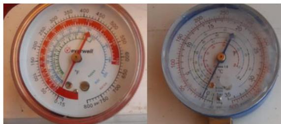
**Figura 9-3:** Manómetro de baja y alta presión
