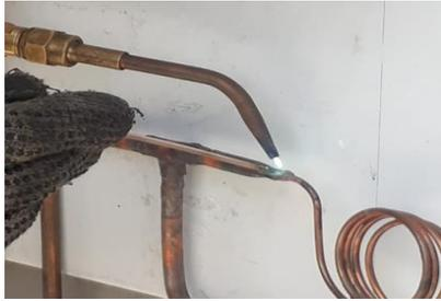
**Figura 27-3:** Soldadura del tubo capilar
