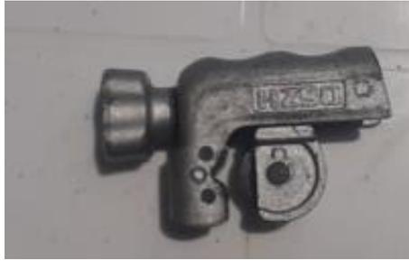
**Figura 15-3:** Cortadora de tubería
