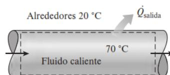
**Figura 14-2:** Pérdida de calor en una tubería
