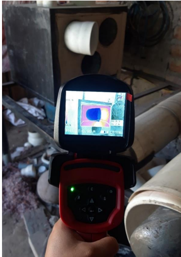
Figura 3-3: Mediciones de temperatura en horno industrial
