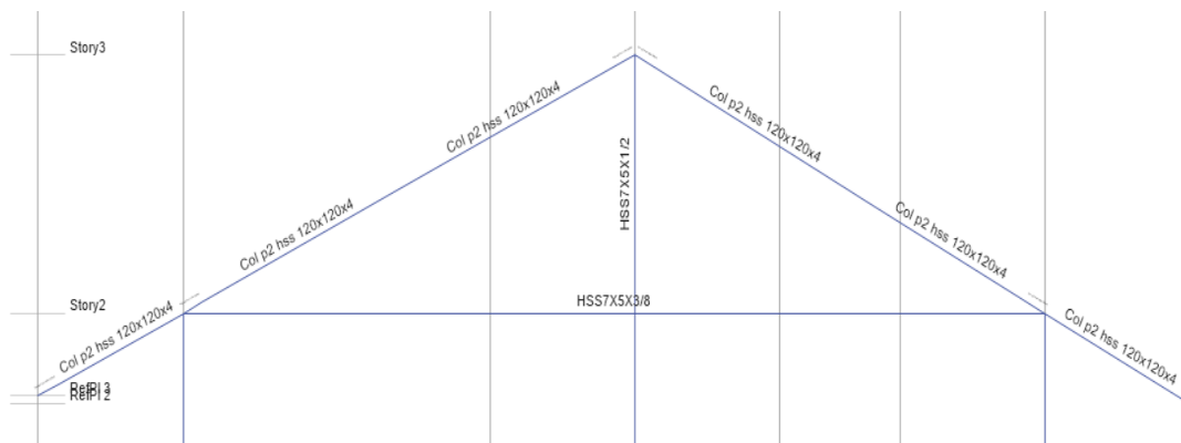
Figura 8-3: Sección de vigas en cubierta inclinada
