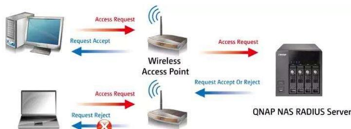
**Figura 19-5.** Esquema de funcionamiento de un servidor RADIUS
