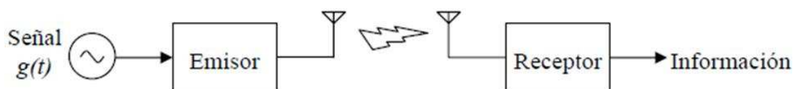
Figura.II.24. Sistema de comunicaciones RF.
