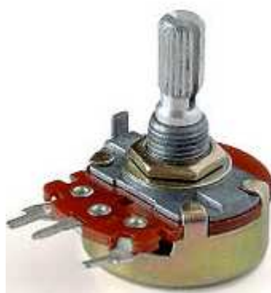
Figura.II.05. Forma física de un Potenciómetro Rotatorio. Fuente: Libro Electrónica practica con microcontroladores.
