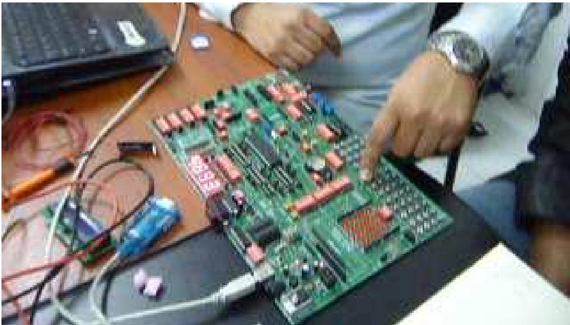
Figura.V.80. Prueba del Display de 7 Segmentos. Fuente: Los Autores.
