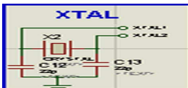
Figura.III.35. Esquema de Conexión del Oscilador Externo.
