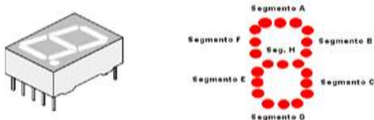
Figura.II.08. Forma física y denominación de los Display de 7 segmentos. Fuente: Libro Electrónica practica con microcontroladores.
