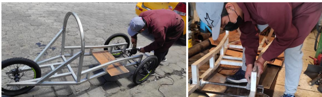
Figura 65-3: Retiro de residuos del sistema de dirección
