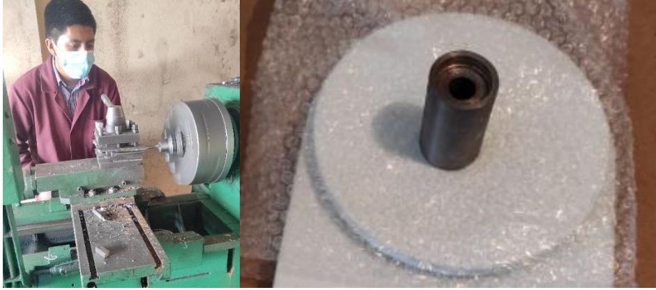
Figura 47-3: Torneado de la mangueta y eje de la mangueta
