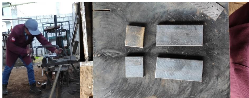
Figura 42-3: Corte de las platinas para los soportes de las bases de la mangueta
