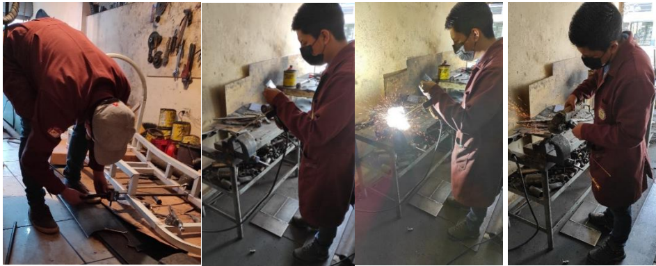
Figura 48-3: Señalización, punteado, soldado y pulido del perno y la mangueta
