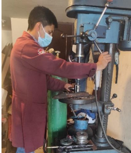
Figura 45-3: Perforación de las bases de la mangueta
