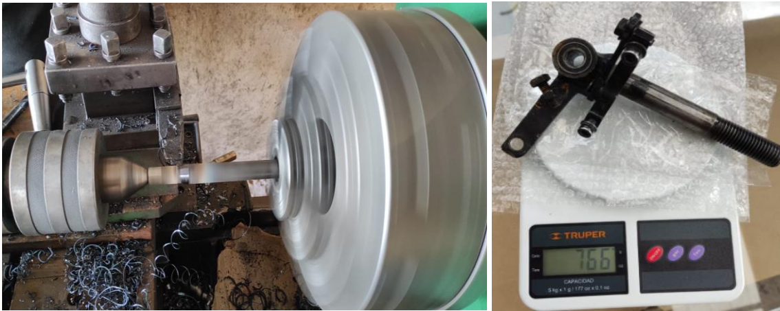
Figura 71-3: Optimización de la mangueta o manzana
