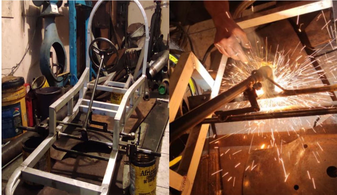
Figura 64-3: Soldadura de los elementos fijos
