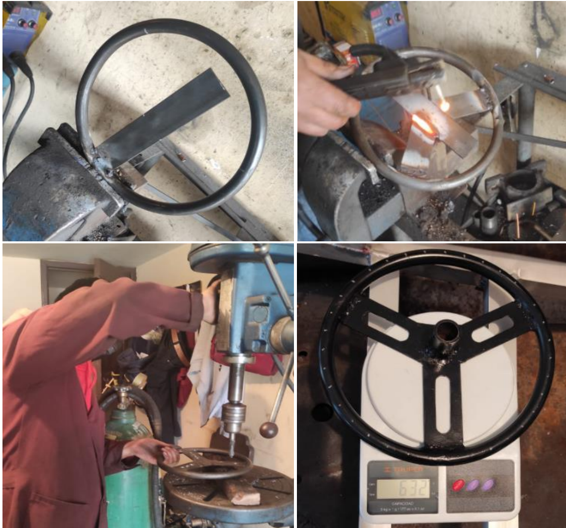
Figura 58-3: Construcción del volante
