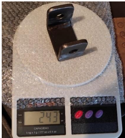
Figura 46-3: Peso de la base de la mangueta en gramos
