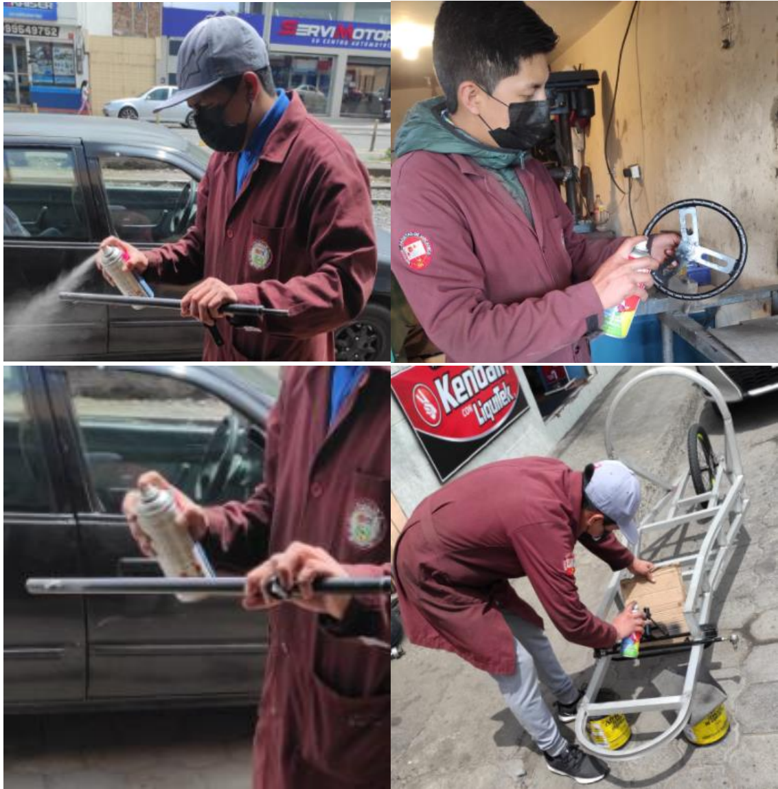
Figura 66-3: Recubrimiento de los elementos con una capa de pintura
