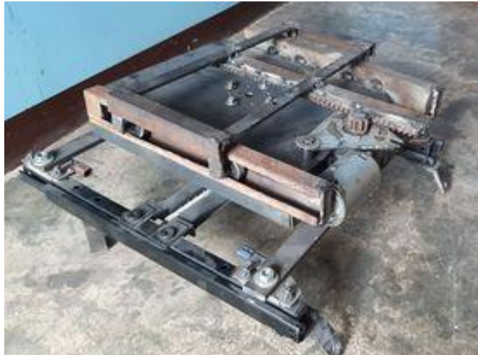
Figura 30-3: Implementación del conjunto de carriles y sistema de piñón cremallera
