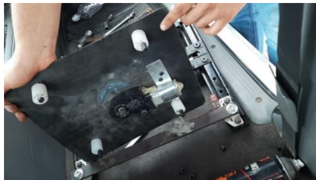
Figura 26-3: Acoplamiento del segundo motor eléctrico
