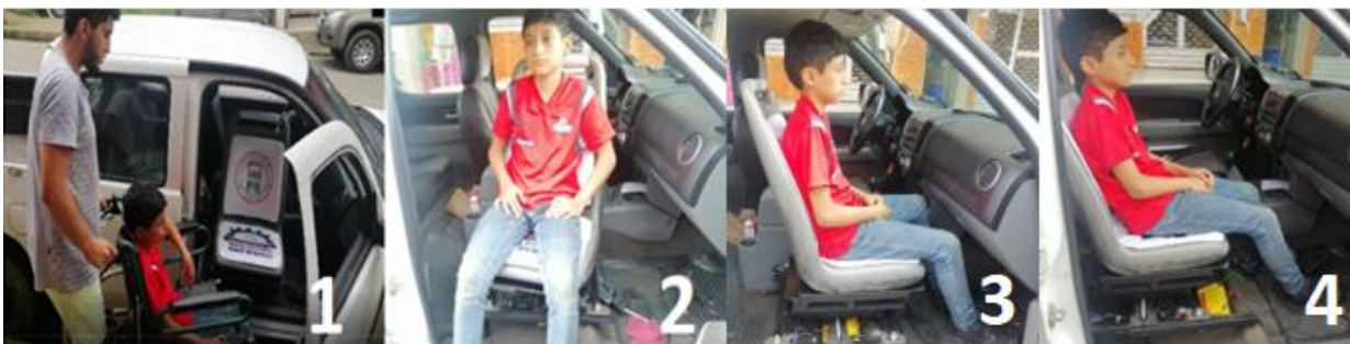
Figura 3-4: Proceso de ingreso al interior del habitáculo (persona en silla de ruedas)
