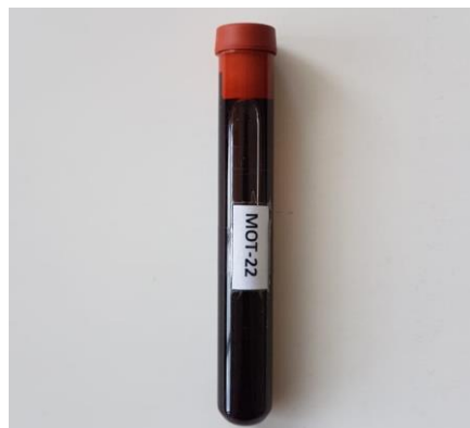
Figura 6-2. Muestra de aceite ATF MOT-22
