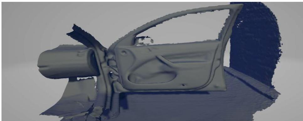
**Figura 4-2.** Geometría 3D de puerta delantera entregado por Scanner 3D iSense
