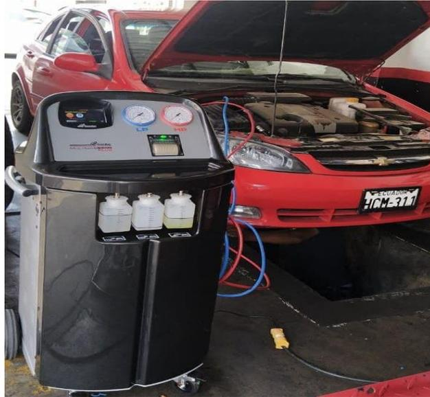
**Figura 10-2.** MULTIGAS 8500 PLUS recargando el sistema de A/C del vehículo
