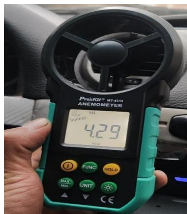
**Figura 17-2.** Velocidad de salida del A/C
