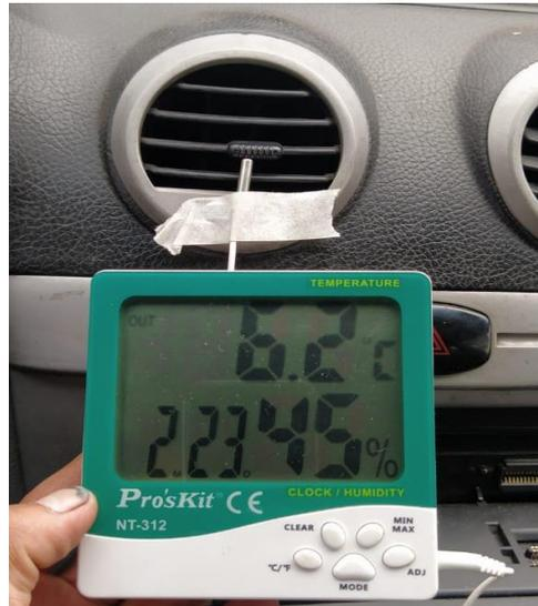
**Figura 16-2.** Temperatura de salida del A/C
