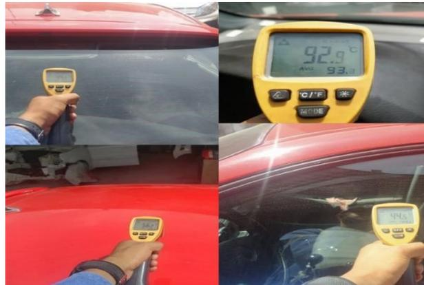
**Figura 14-2.** Temperaturas en las superficies del vehículo
