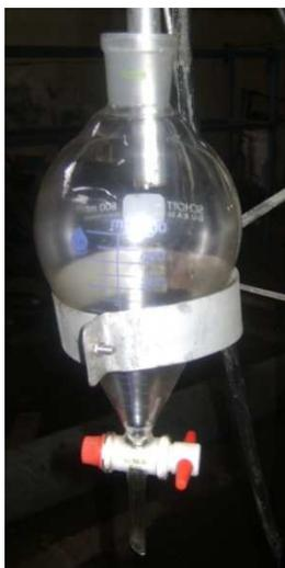
**Figura 5.47. Ensamble del vaso separador.**
