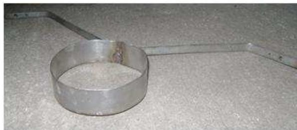
**Figura 5.14. Soporte del vaso separador**
