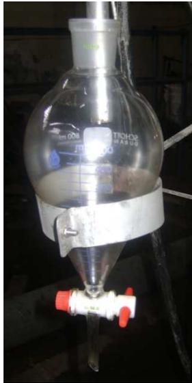
**Figura 5.39. Ensamble vaso separador.**
