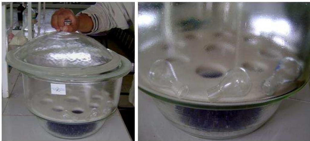
**Figura 5.56. Colocación de picnómetros en el desecador.**
