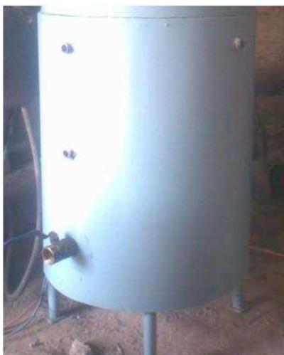
**Figura 5.4. Entradas y salidas del generador de vapor**
