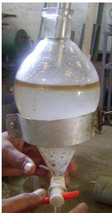
**Figura 5.31. Aceite esencial de eucalipto en el vaso separador.**
