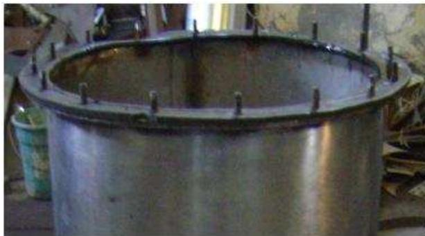
**Figura 5.6. Bridas con pernos de ajuste del extractor**
