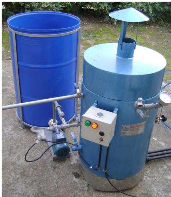
**Figura 5.5. Generador de vapor**
