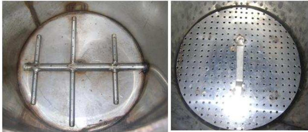
**Figura 5.23. Ensamble del tamiz sobre el distribuidor.**
