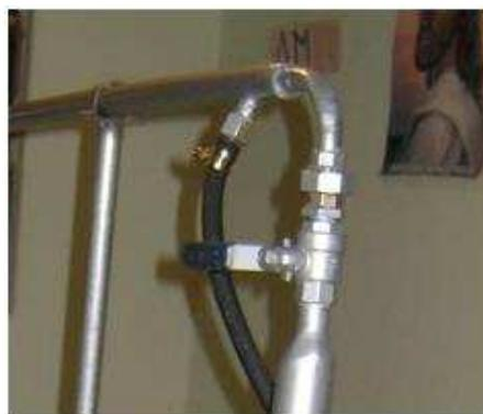
**Figura 5.29. Ensamble del condensador**
