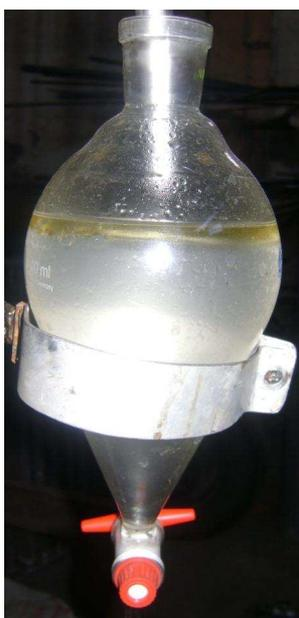
**Figura 5.48. Aceite esencial de ciprés en el vaso separador.**
