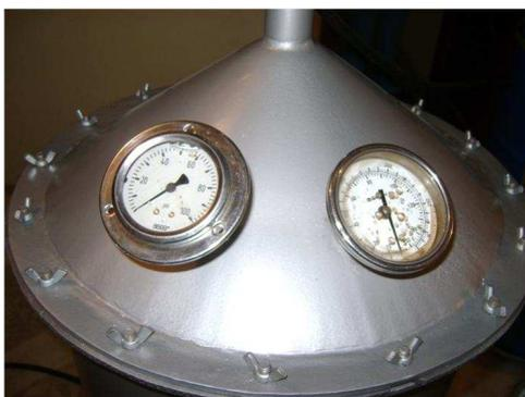
**Figura 5.25. Ensamble de las mariposas en la tapa cónica.**
