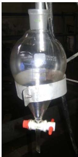
**Figura 5.30. Ensamble del vaso separador**
