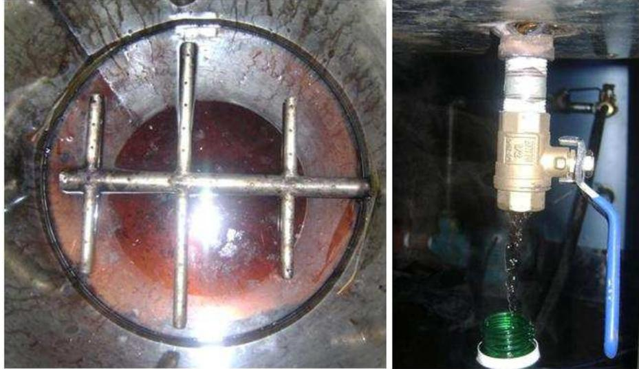
**Figura 5.33. Purgado del agua aromatizada.**
