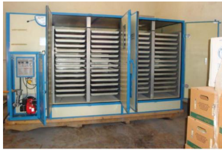
Figura 1-1: Deshidratadora de gas LP
