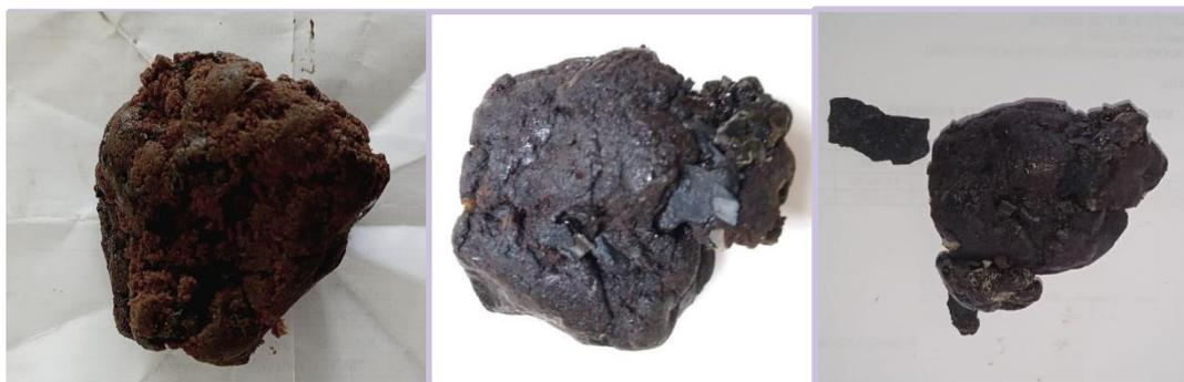
**Figura 2-3.** Fracción sólida al 1%, 2% y sin catalizador (de izquierda a derecha)
