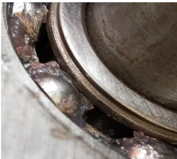
**Figura 28-3:** Ralladuras en la pista interna del rodamiento.
