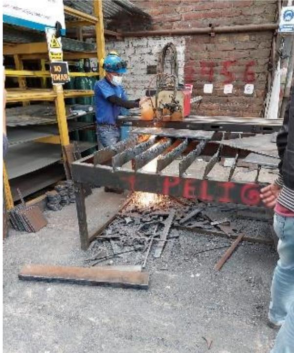
**Figura 18-3:** Corte de las piezas del módulo de simulación.
