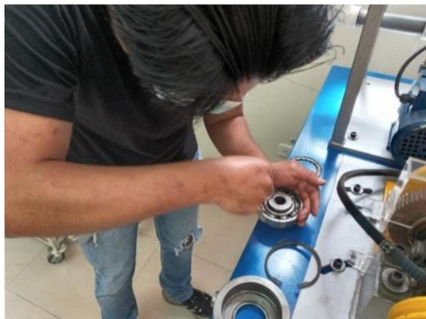
**Figura 25-3:** Inducción de ralladuras en la pista externa del rodamiento.
