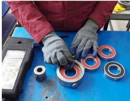
Ratificamos que el seguro del rodamiento este correctamente colocado. Lo cual ayudará a evitar el desplazamiento del rodamiento dentro del porta rodamientos, como en la figura:
