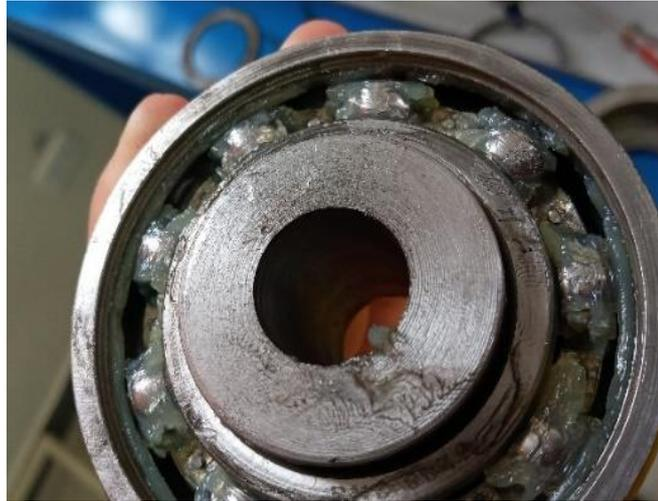
**Figura 26-3:** Ralladuras en la pista externa del rodamiento.
