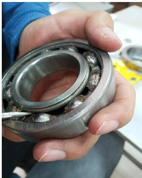
**Figura 29-3:** Elaboración de defectos en la pista interna.
