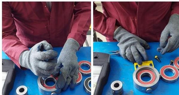
Después, colocamos el bocín dentro del rodamiento para poder asegurarlo en el eje de transmisión, como se ve en la siguiente figura:
