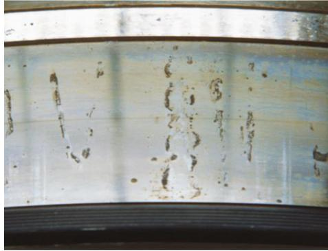
**Figura 11-2:** Anillo interior de un rodamiento de rodillos esféricos.
