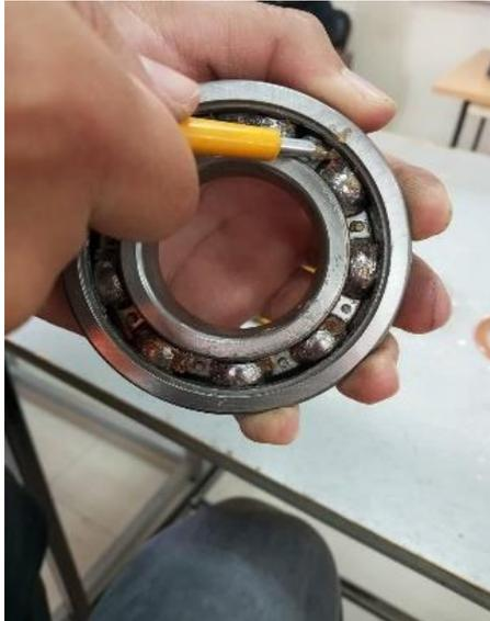
**Figura 30-3:** Elaboración de defectos en la pista externa.
