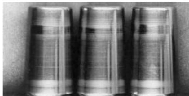
**Figura 22-2:** Huella de desgaste en la superficie del elemento rodante.
