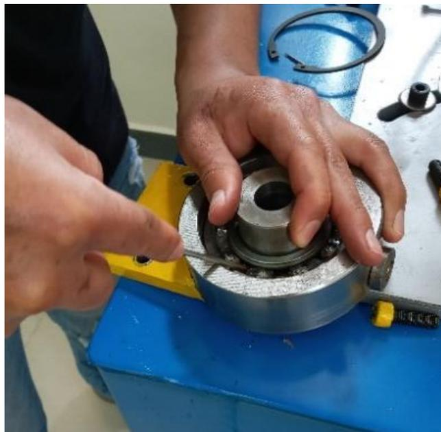
**Figura 27-3:** Inducción de ralladuras en la pista interna del rodamiento.
