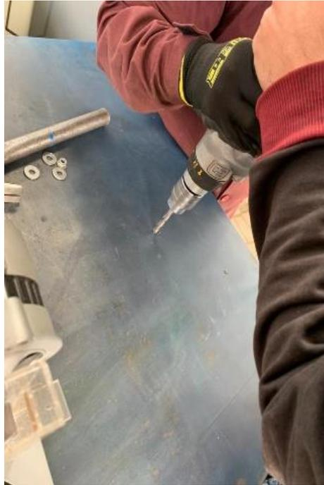
**Figura 22-3:** Perforación de los huecos para la sujeción.
