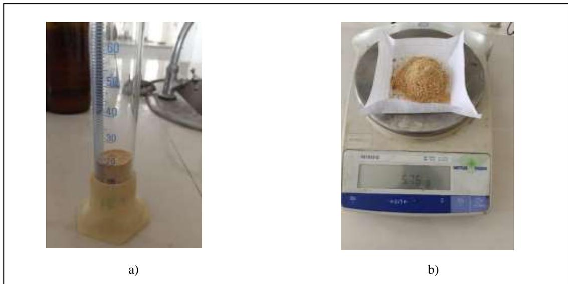
**Figura 4-2.** a) medición del volumen de la muestra, b) pesaje de la muestra
