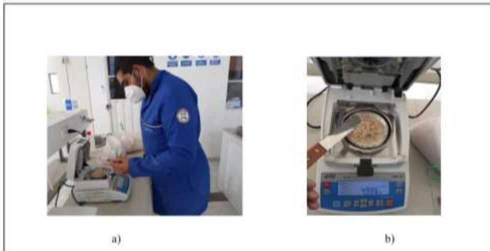
**Figura 3-2.** a) colocación de la muestra en la balanza de humedad, b) medición en la balanza de humedad
