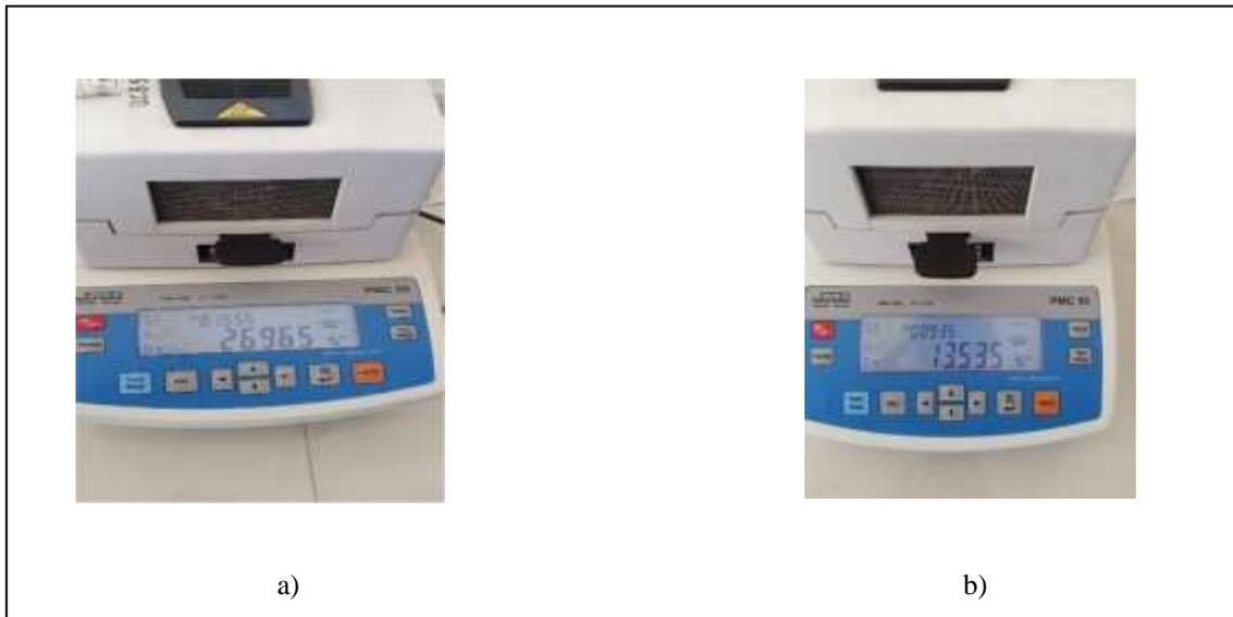
**Figura 1-3.** a) contenido de humedad del aserrín fino, b) contenido de humedad del aserrín grueso
