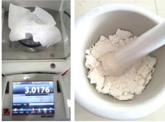
**Figura 13-2.** Fracción sólida despolimerizada
