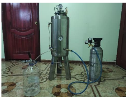
Figura 23-3: Tanque de carbonatación Realizado por: Córdova Paula, Romero Romy, 2021.
