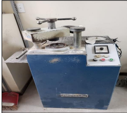
Fotografía 3-3: Prensa automática del laboratorio de Cemento Chimborazo.
