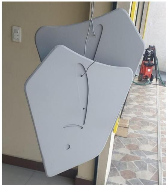
**Figura 57-3:** Preparación de los *endplates* previos a ser pintados
