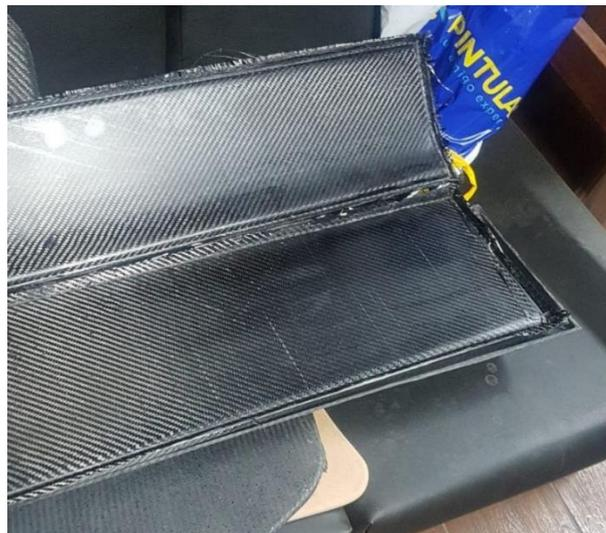
**Figura 53-3:** Estructura interna del alerón *flap*
