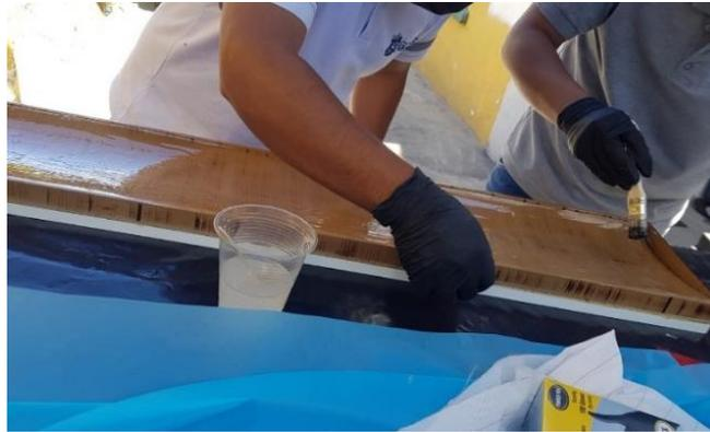
**Figura 42-3:** Colocación de resina y fibra en el molde
