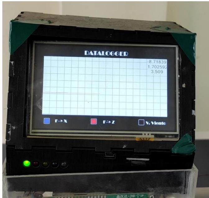
**Figura 76-3:** Módulo de control del túnel de viento
