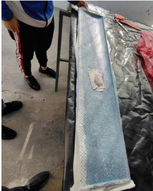
**Figura 46-3:** Aplicación de manta de absorción
