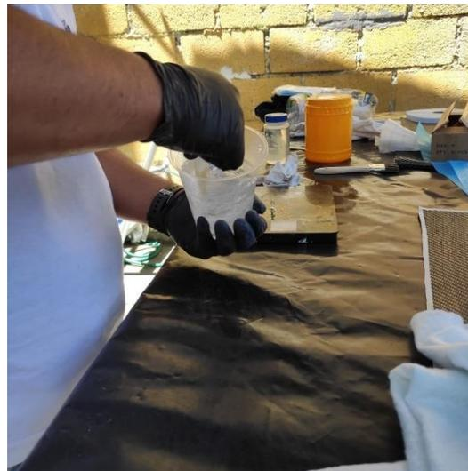
**Figura 41-3:** Mezcla de la resina y catalizador
