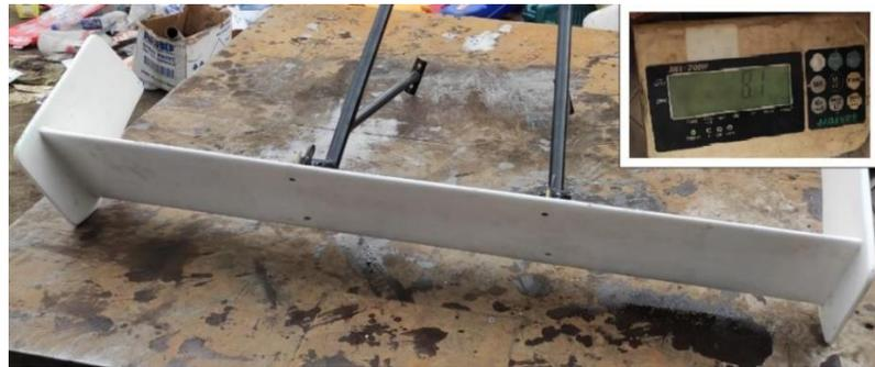
**Figura 3-4:** Medición de peso del alerón cabuya
