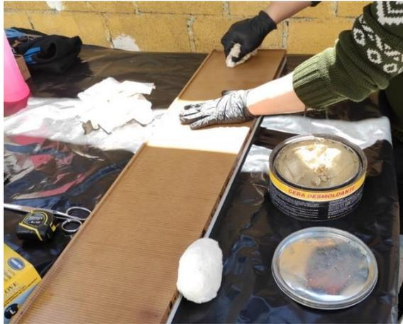
**Figura 36-3:** Purificación de los moldes
