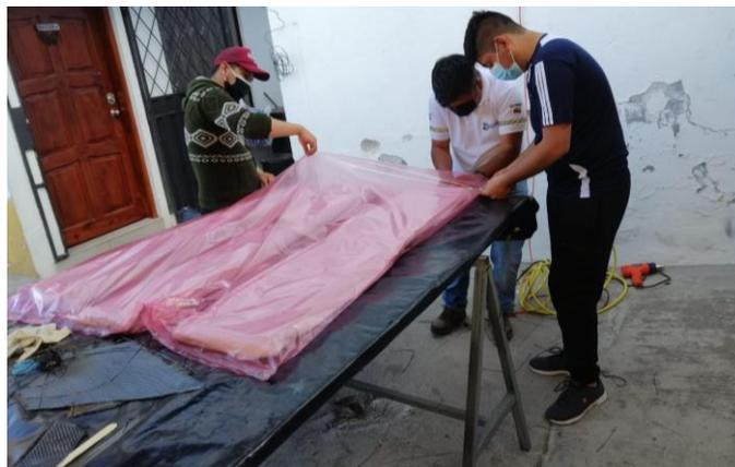
**Figura 47-3:** Aplicación de la bolsa de vacío
