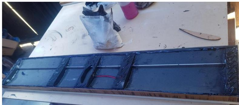
**Figura 51-3:** Estructura interna del alerón principal
