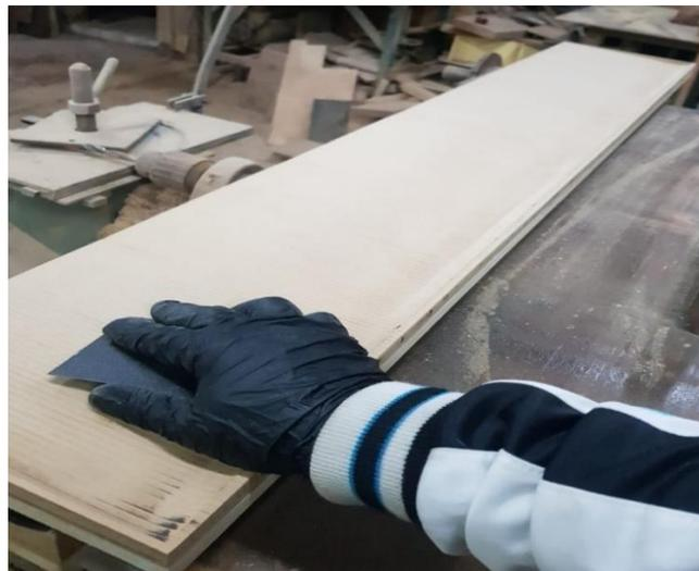
**Figura 34-3:** Proceso de lijado en cada uno de los moldes
