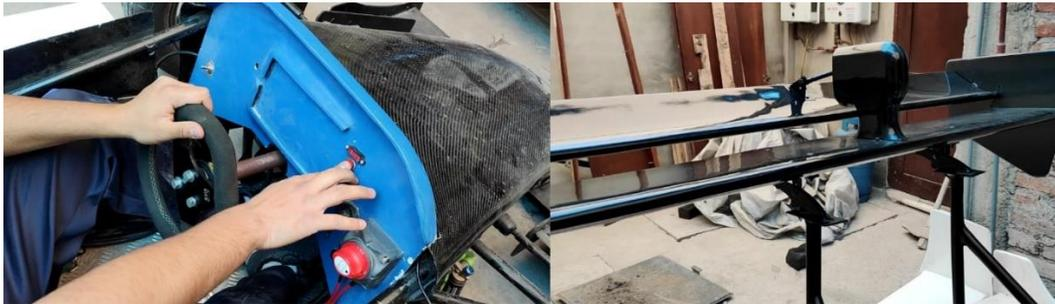
**Figura 40-4:** Activación del sistema *DRS* a través de botón de encendido
