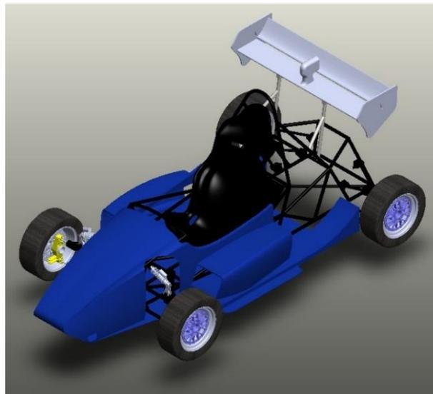
**Figura 69-3:** Escalado 1:10 del prototipo SAE con sistema *DRS*
