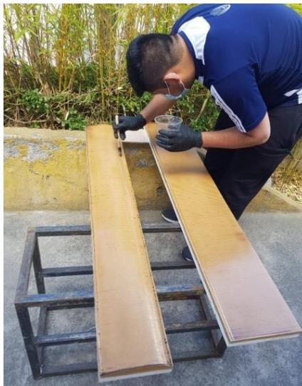
**Figura 37-3:** Aplicación de cera desmoldante
