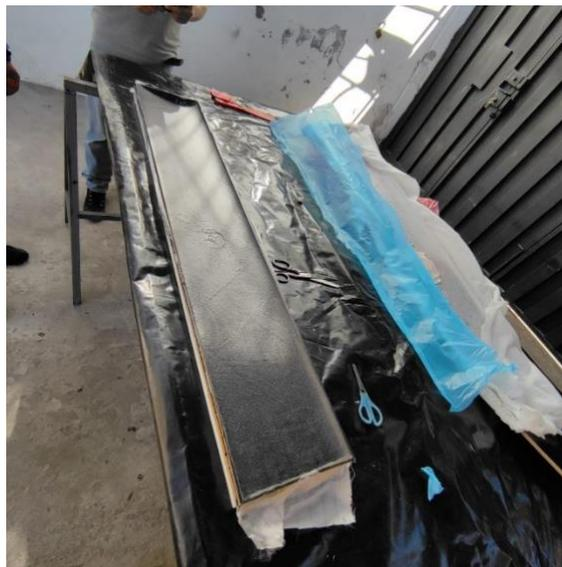
**Figura 43-3:** Aplicación de capas de fibra de carbono
