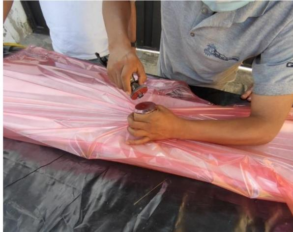
**Figura 48-3:** Conexión de la válvula de vacío a la bomba
