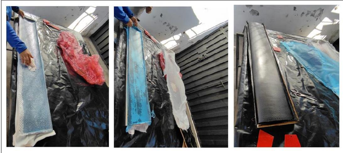
**Figura 50-3:** Desprendimiento de materiales de cada molde
