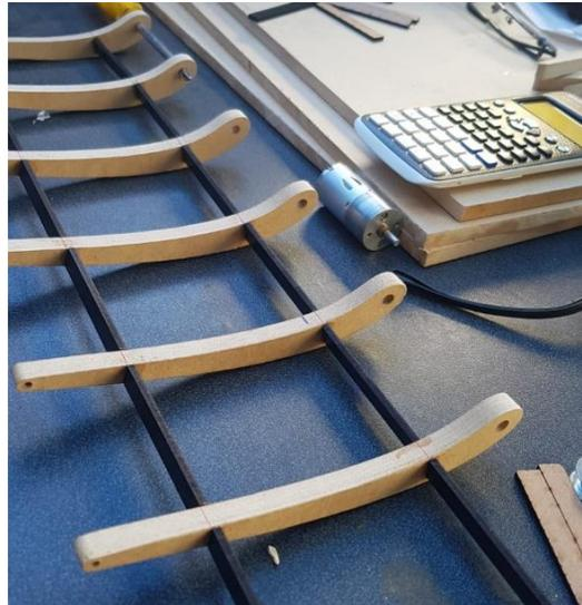
**Figura 52-3:** Estructura interna del alerón flap
