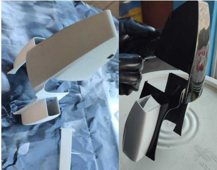
**Figura 72-3:** Impresión completa del prototipo SAE con sistema DRS
