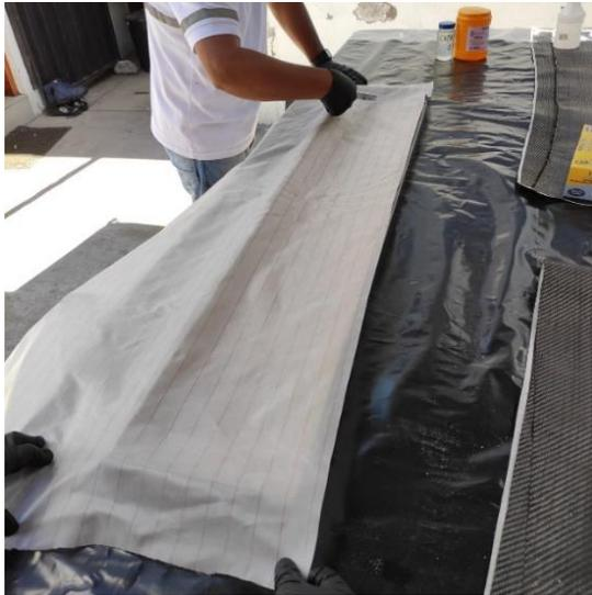
**Figura 44-3:** Aplicación del *Peel Ply*
