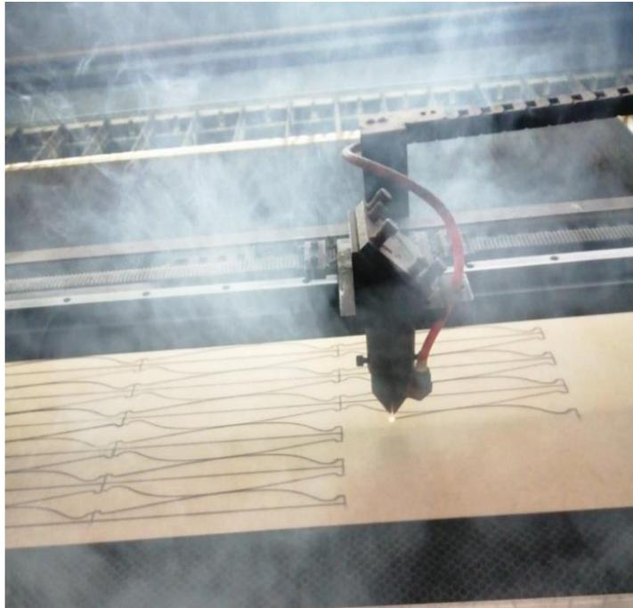
**Figura 31-3:** Proceso de corte en la maquina laser
