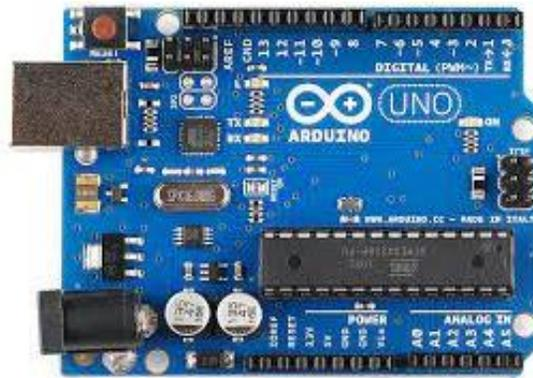
**Figura 27-2:** Placa Arduino Microcontrolador
