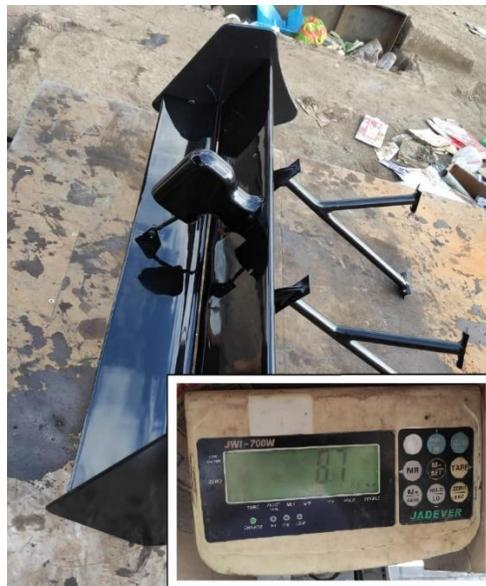
**Figura 4-4:** Medición de peso del alerón con sistema *DRS*
