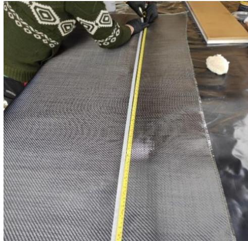
**Figura 38-3:** Medición y corte de la fibra de carbono
