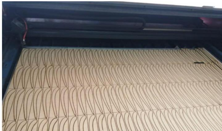
**Figura 32-3:** Piezas cortadas en la maquina laser
