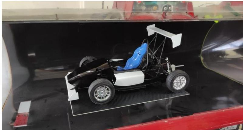
**Figura 75-3:** Modelo a escala en el túnel de viento
