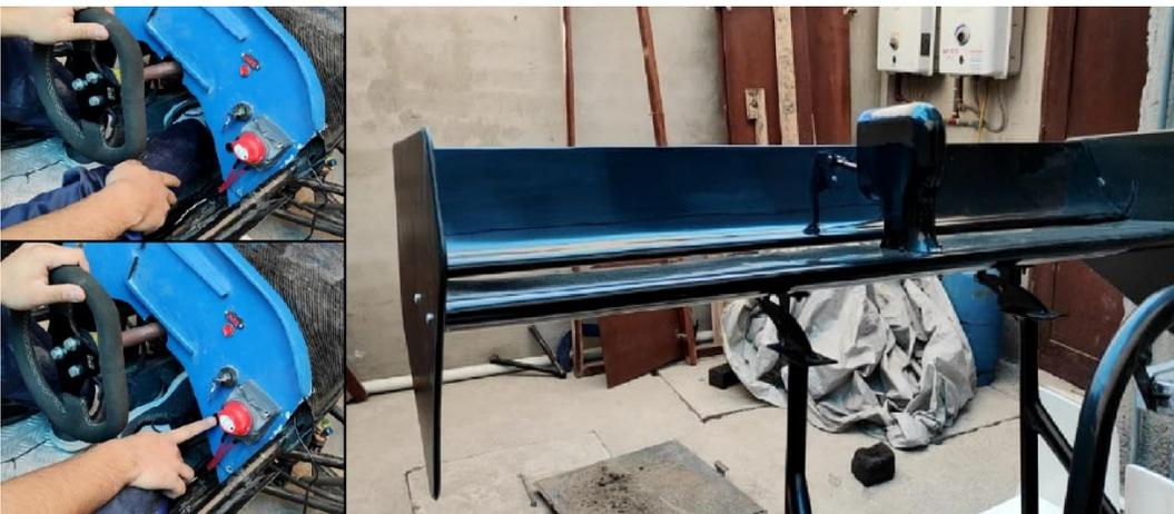
**Figura 2-4:** Desactivación del sistema *DRS* a través del pedal y el botón de emergencia
