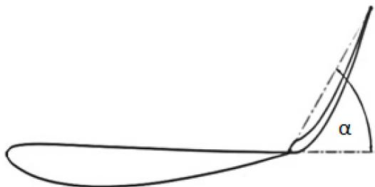
**Figura 14-3:** Modificación de ángulo de ataque del flap
