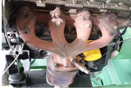
Figura 11-2: Instalación de la termocupla Realizado por: (PADILLA, F & GAULLO, L, 2022)
