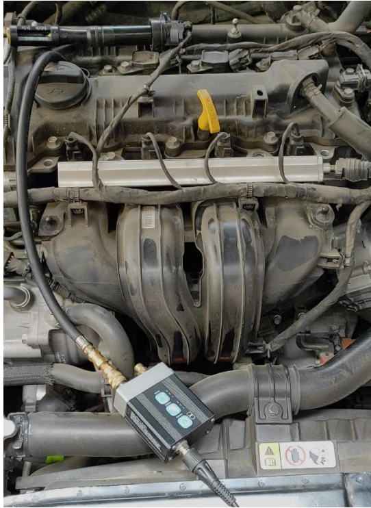
Figura 14-3: Conexión del transductor de presión al cilindro en lugar de la bujía
