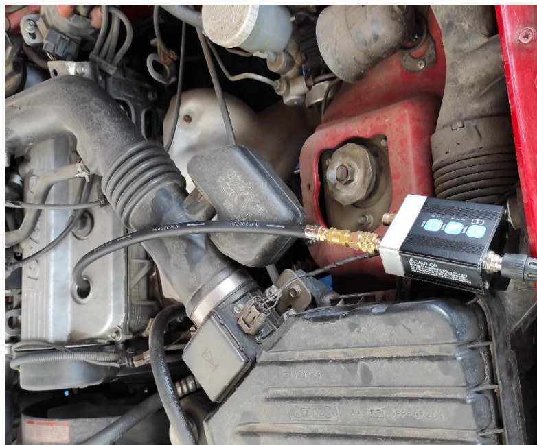
Figura 17-3: Conexión de traductor de presión al cilindro del vehículo convencional
