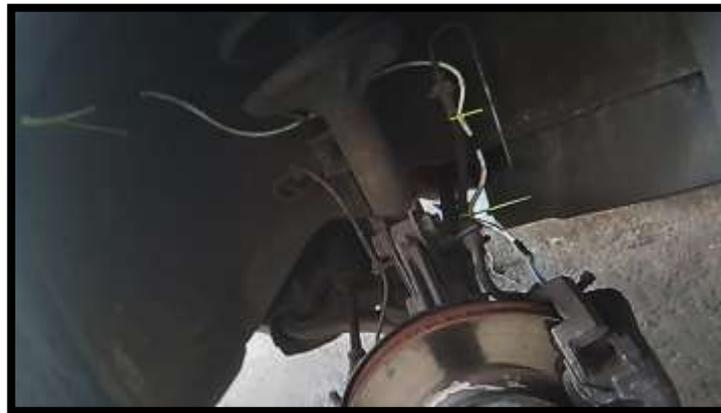
**Figura 32-2:** Instalación del cableado de los sensores a través del guardalodos del vehículo
