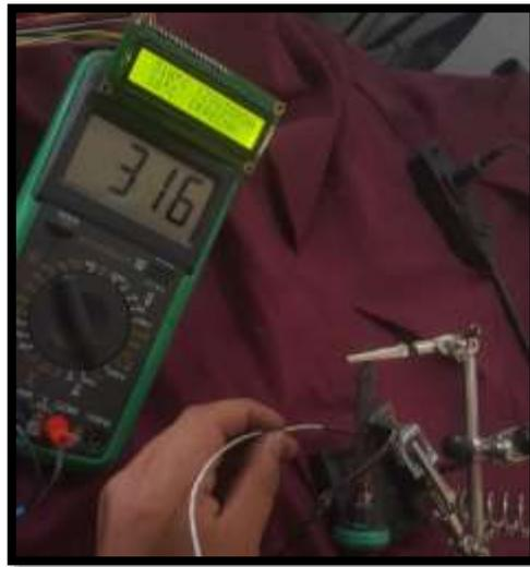
**Figura 36-2:** Verificación de calibración del sensor MLX90614
