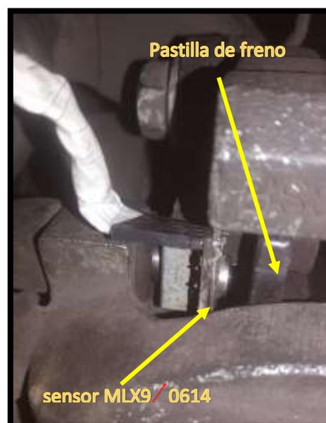
**Figura 35-2:** Instalación del sensor MLX90614 en las mordazas
