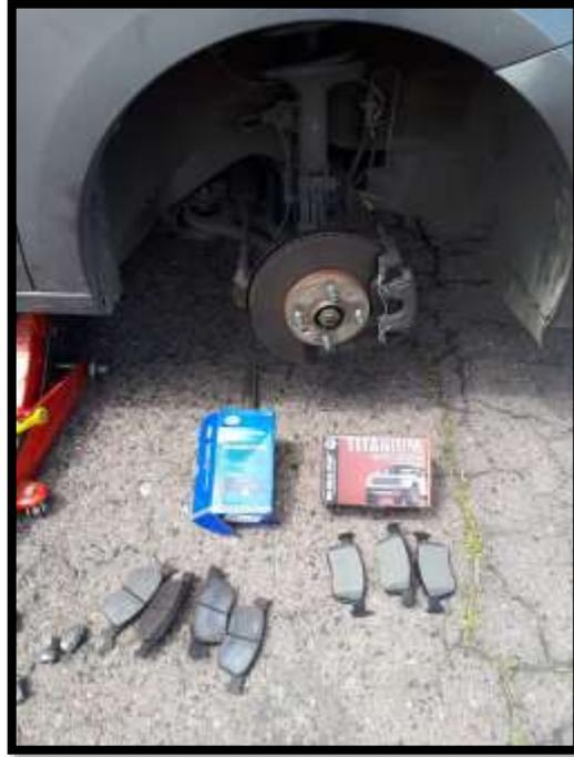
**Figura 45-2:** Cambio de pastillas para su acondicionamiento
