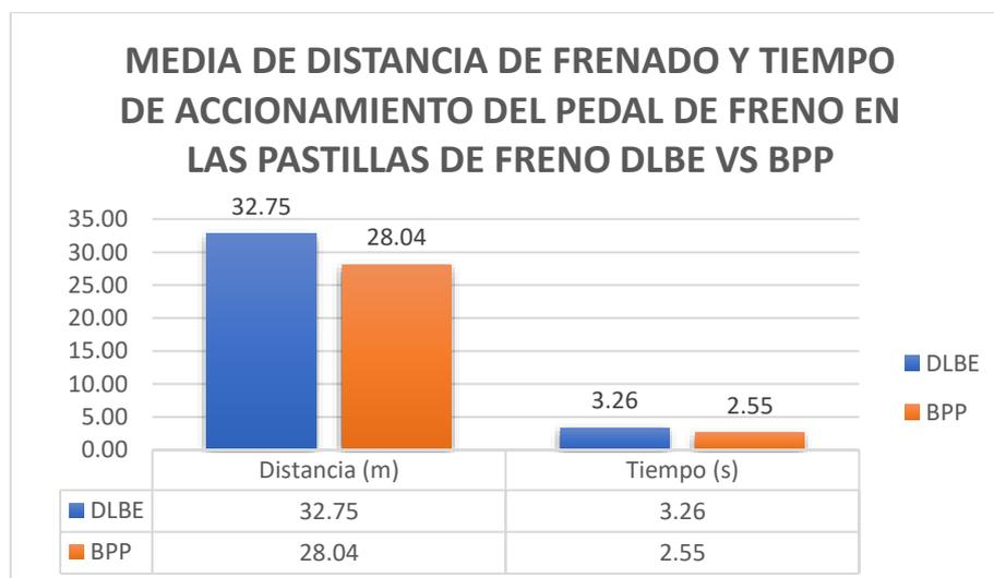
**Gráfico 25-3:** Comparativa de las distancias de frenado y el tiempo de accionamiento del pedal de freno de las pastillas de freno Double Link Brake (DLBE) y Brake Pak (BPP).
