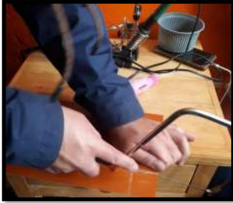
**Figura 24-2:** Corte de la baquelita para el revelado
