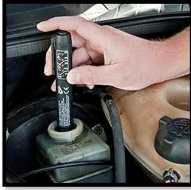
**Figura 7-1:** Utilización del comprobador de humedad
