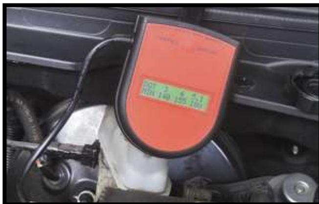
**Figura 6-1:** Utilización del Higrómetro
