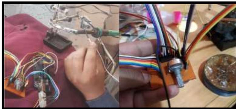
**Figura 26-2:** Proceso de soldadura de los componentes electrónicos
