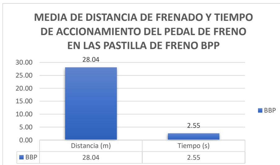
**Gráfico 22-3:** Media de la distancia de frenado y tiempo de accionamiento del pedal del freno en las pastillas de freno Brake Pak (BPP).
