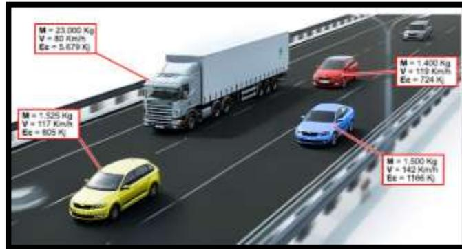
**Figura 10-1:** Efecto de la masa de un automóvil sobre la energía cinética
