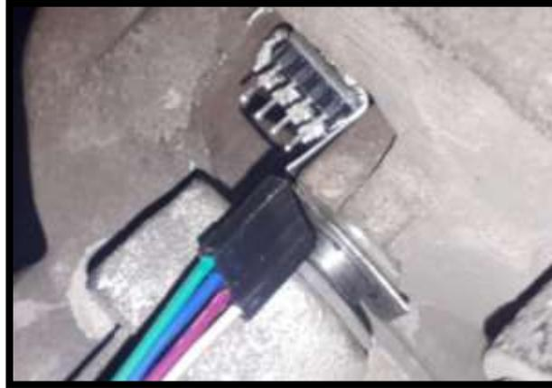
**Figura 31-2:** Instalación del sensor de temperatura en las mordazas de los discos
