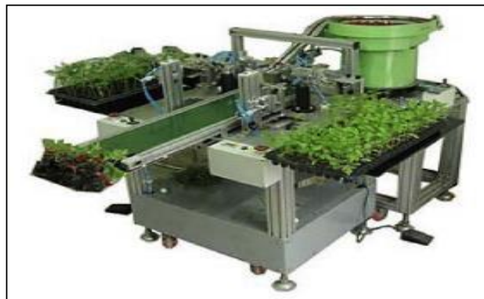
Figura 3-1. Máquina de injerto semiautomática desarrollada por Helper Robotech en Corea.
