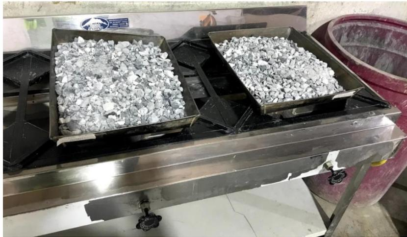
**Figura 1-4:** Secado de muestras en hornillas a fuego lento
