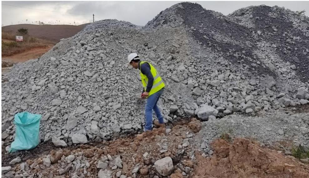
**Figura 2-3:** Proceso de muestreo de material de Pique para pruebas metalúrgicas
