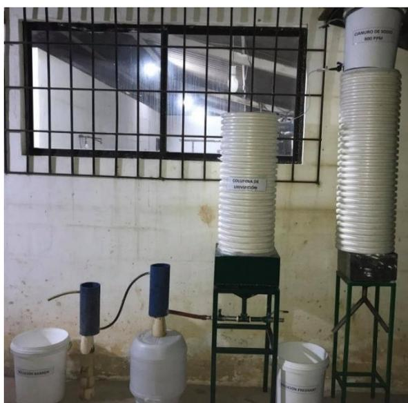
**Figura 14-3:** Instalación de Columna de lixiviación
