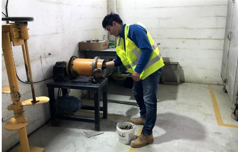
**Figura 6-3:** Preparación de molino de bolas para pulverizar la muestra
