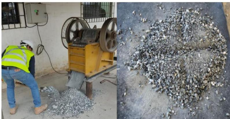
**Figura 3-3:** A. Reducción tamaño de material en trituradora de mandíbulas. B. Cuarteo
