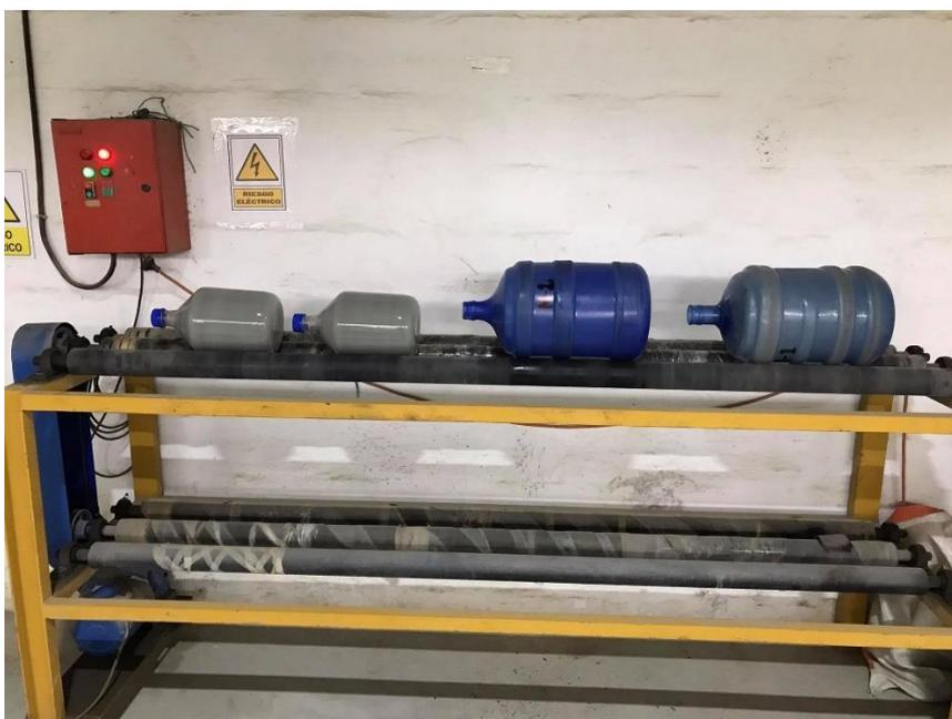
**Figura 9-3:** Colocación de botellas por duplicado en el agitador de rodillos para prueba de cianuración
