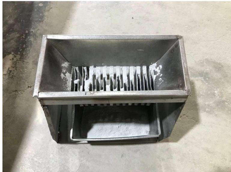
**Figura 7-3:** Homogenización y cuarteo de muestra
