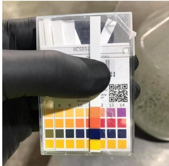
**Figura 10-3:** Medición de pH (>11) para prueba de cianuración en botella
