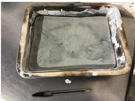
**Figura 13-3:** Lavado de pulpa con floculante
