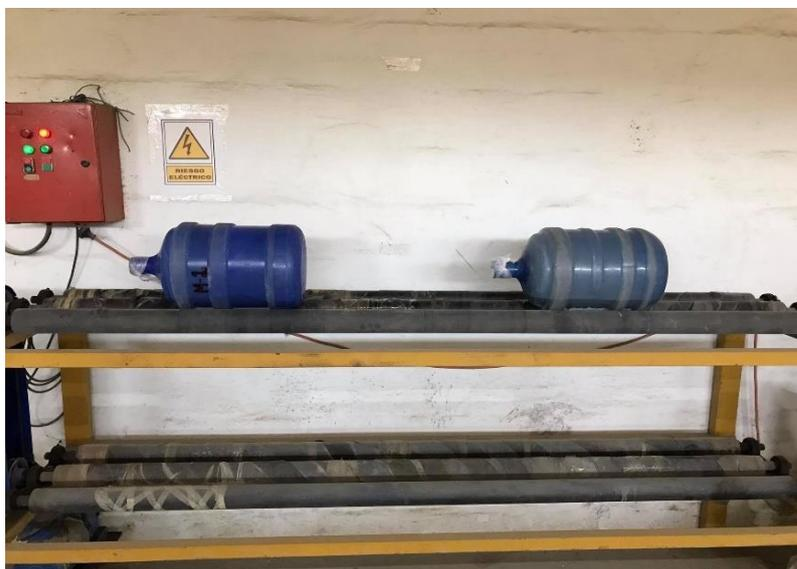
**Figura 4-3:** Proceso de agitación de botellas en agitador de rodillos
