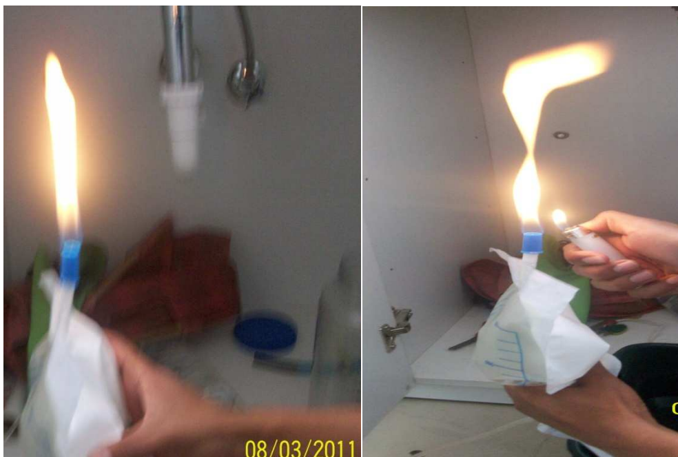
La llama indica la presencia de biogás
