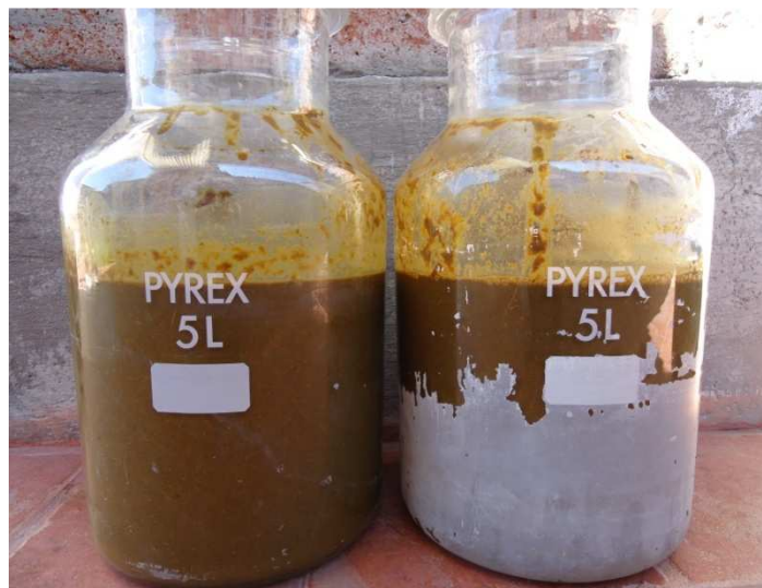
Biorreactores 1 y 2: mezcla de agua 1700g de estiércol y 1.7 litros de agua.
