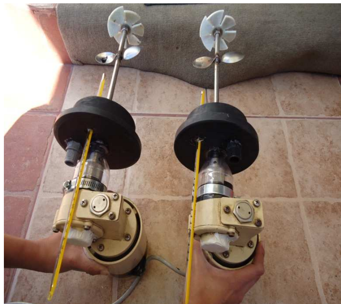
Tapas de los biorreactores 1 y 2: incluyen termómetros y agitador mecánico.
