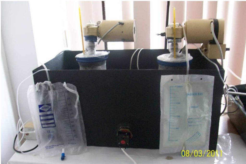
Fundas Tedlar incorporadas al sistema de biodigestión
