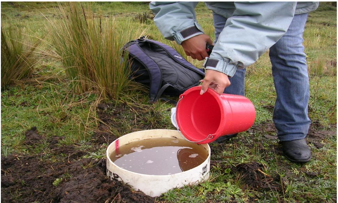
FOTOGRAFÍA No 13: PRUEBA DE INFILTRACIÓN
