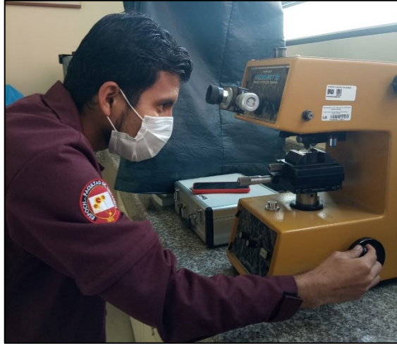
Figura 9-2: Montaje de la muestra AISI 1018 en el micro durómetro Micromet II.
