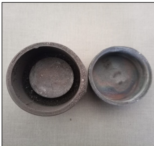
Figura 18-2. Desmontaje de la probeta AISI 1018 en el contenedor.
