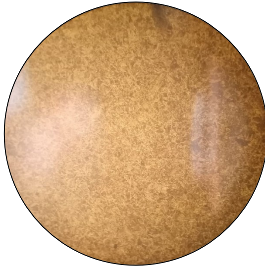
Figura 12-3. Muestra 6. (Extremo). Martensita revenida. Prueba a 1183°K/16,82horas con tratamiento térmico bonificado. Aumento 500x. Reactivo Nital.
