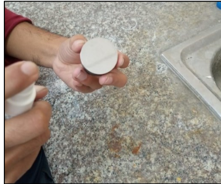
Figura 7-2: Proceso de lavado de la probeta AISI 1018.
