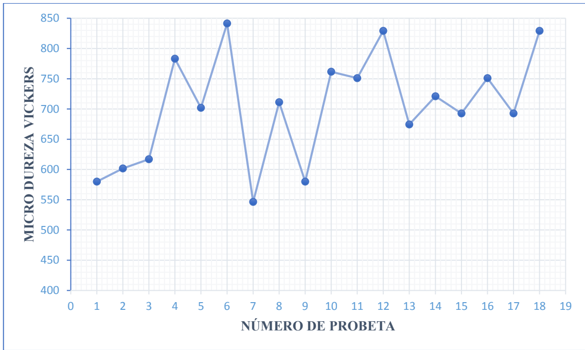
Gráfico 21-3: Micro dureza superficial HV 2 de las probetas posterior a una carburización sólida.
