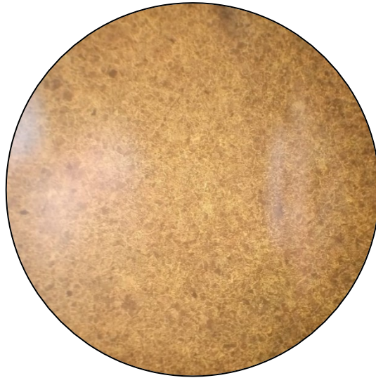
Figura 8-3. Muestra 4. (Extremo). Martensita revenida. Prueba a 1183°K/11,22horas con tratamiento térmico bonificado. Aumento 500x. Reactivo Nital.
