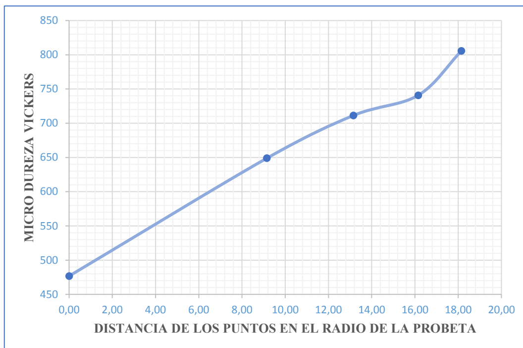
Gráfico 19-3: Micro dureza de la probeta AISI 1018 carburizada con condiciones: %C=0,60%, una capa de profundidad de 1,25 milímetros y un tiempo de 11,16 horas.
