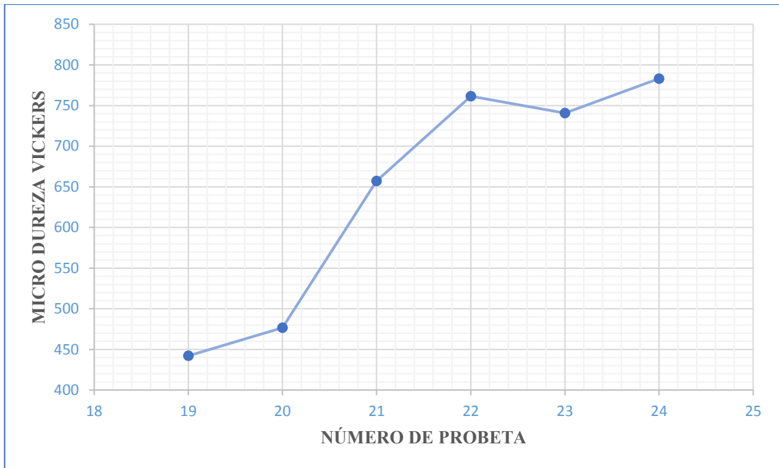
Gráfica 23-3: Micro dureza superficial HV 1 de las probetas posterior a una carburización líquida.
