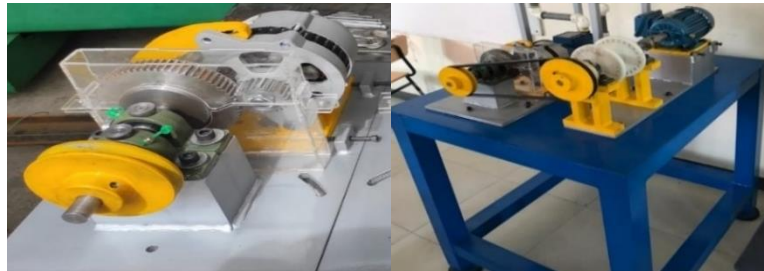
Figura 26-3: Módulo de simulación de fallas en poleas.
