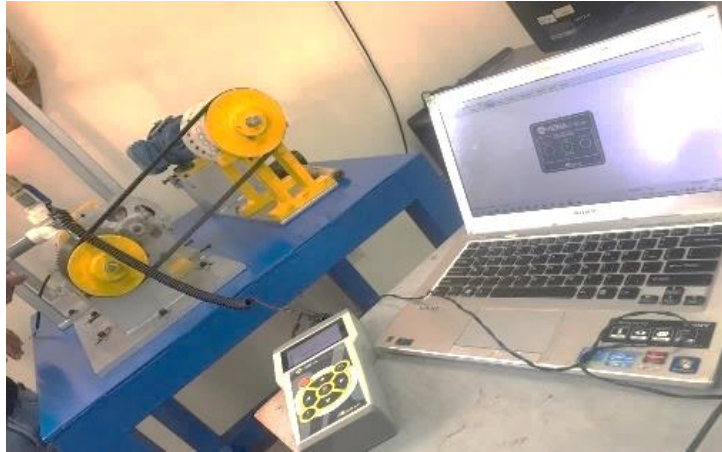
Figura 29-3: Módulo simulador de fallas.
