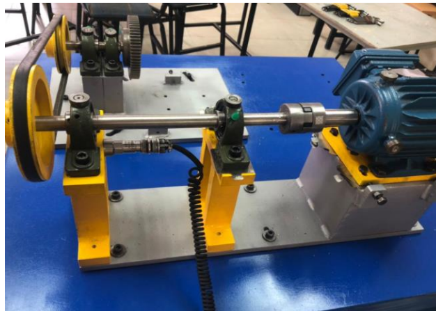
Figura 7-4: Medición en el apoyo axial
