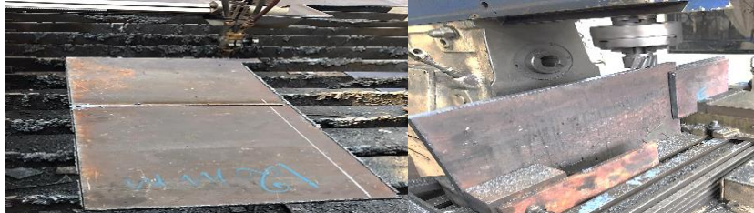
Figura 21-3: Corte de placas bases para el módulo.
