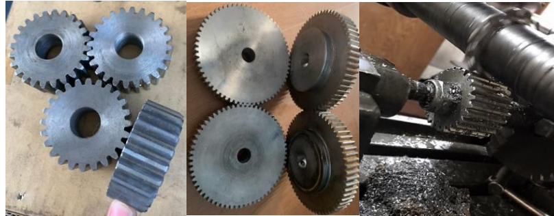
Figura 23-3: Construcción de ruedas dentadas.
