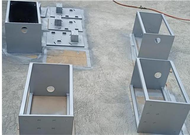
**Figura 17-3:** Proceso de aplicación de fondo y pintura
