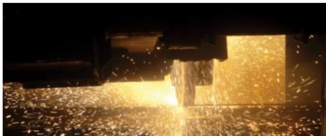
**Figura 14-3:** Rectificado de las planchas superior e inferior
