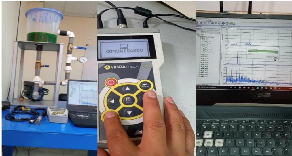
**Figura 3-4:** Medición y detección de excentricidad estática en el motor de inducción
