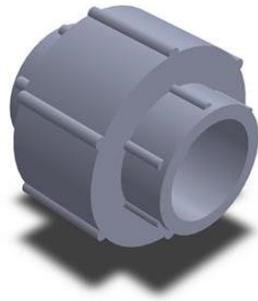
**Figura 8-3:** Vista isométrica de la unión universal
