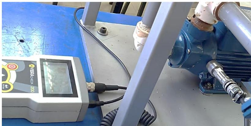
**Figura 1-4:** Ubicación del acelerómetro en dirección radial horizontal
