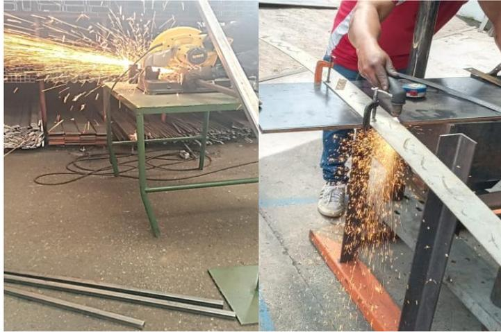
**Figura 13-3:** Proceso de corte de tubos cuadrados y planchas
