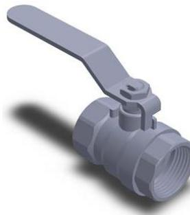
**Figura 9-3:** Vista isométrica de la válvula de esfera
