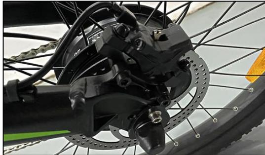
**Figura 12-1.** Motor bicicleta eléctrica
