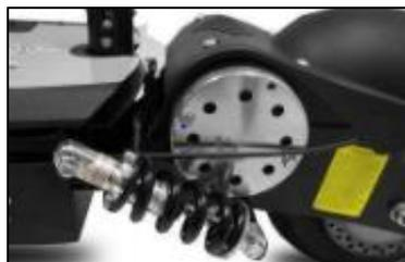
**Figura 2-1.** Motor eléctrico
