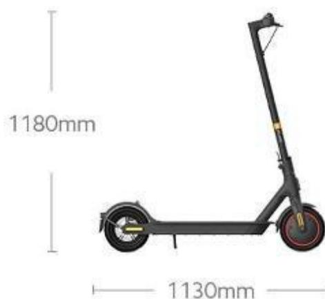
**Figura 14-1.** Dimensiones del Xiaomi electric scooter pro2 (desplegado)
