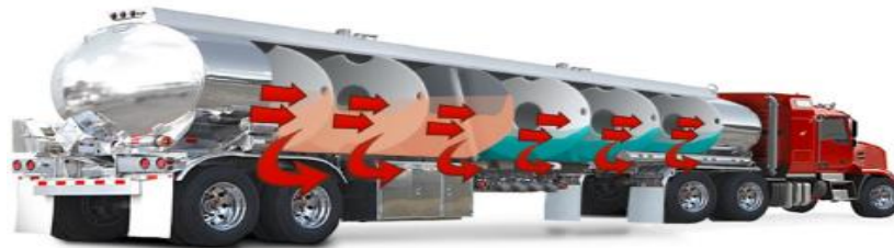
Figura 2. Sistema tradicional de espejos estructurales para disipar el fenómeno de chapoteo de combustible.
