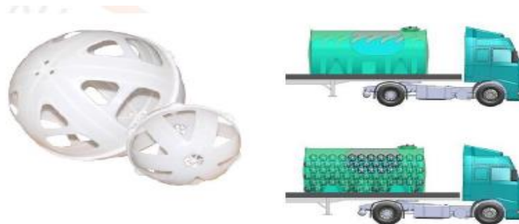
Figura 3. Sistema de balones para disipar efecto de chapoteo de combustible.
