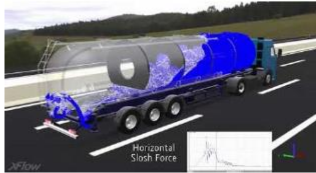
Figura 13-1. Fenómeno de chapoteo al frenar el Vehículo, simulación computación por el método DEM.
