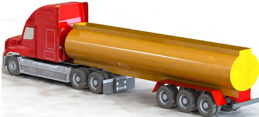
Figura 2-2. Vista isométrica solida de auto-tanque destinado al transporte de combustibles.
