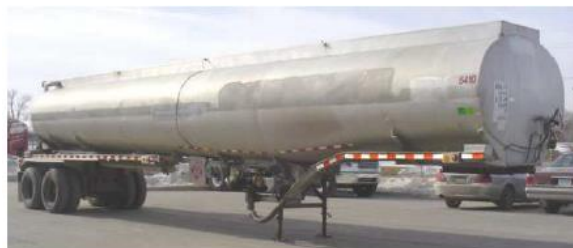
Figura 10-1. Semirremolques cisterna de dos ejes con tanque elíptico para capacidad de 10000 galones.
