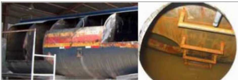
Figura 15-1. Rompeolas utilizados en el autotransporte de combustibles Fuente: (Gallegos C. et al., 2006).
