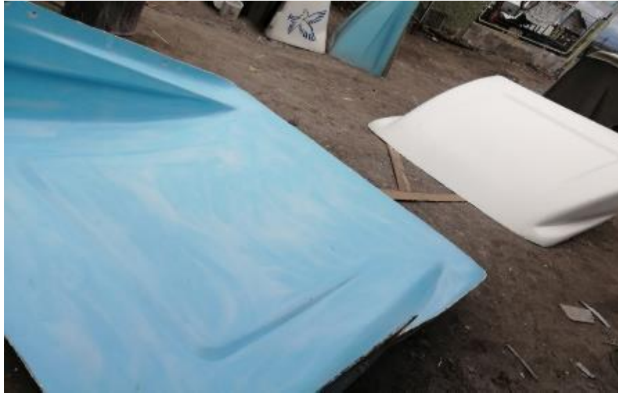
Figura 6-3: Desmoldado del deflector
