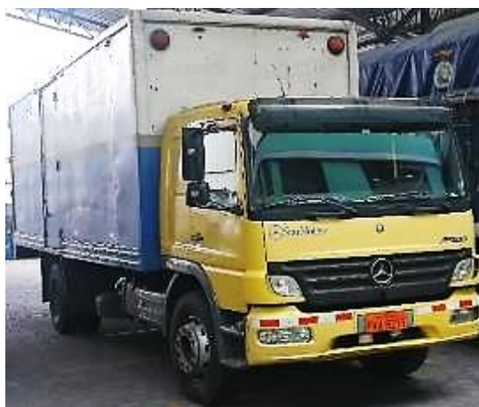
Figura 17-3: Vehículo de pruebas sin deflector.
