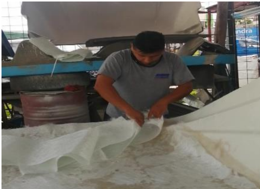
Figura 5-3: Aplicación de la fibra de vidrio sobre la matriz
