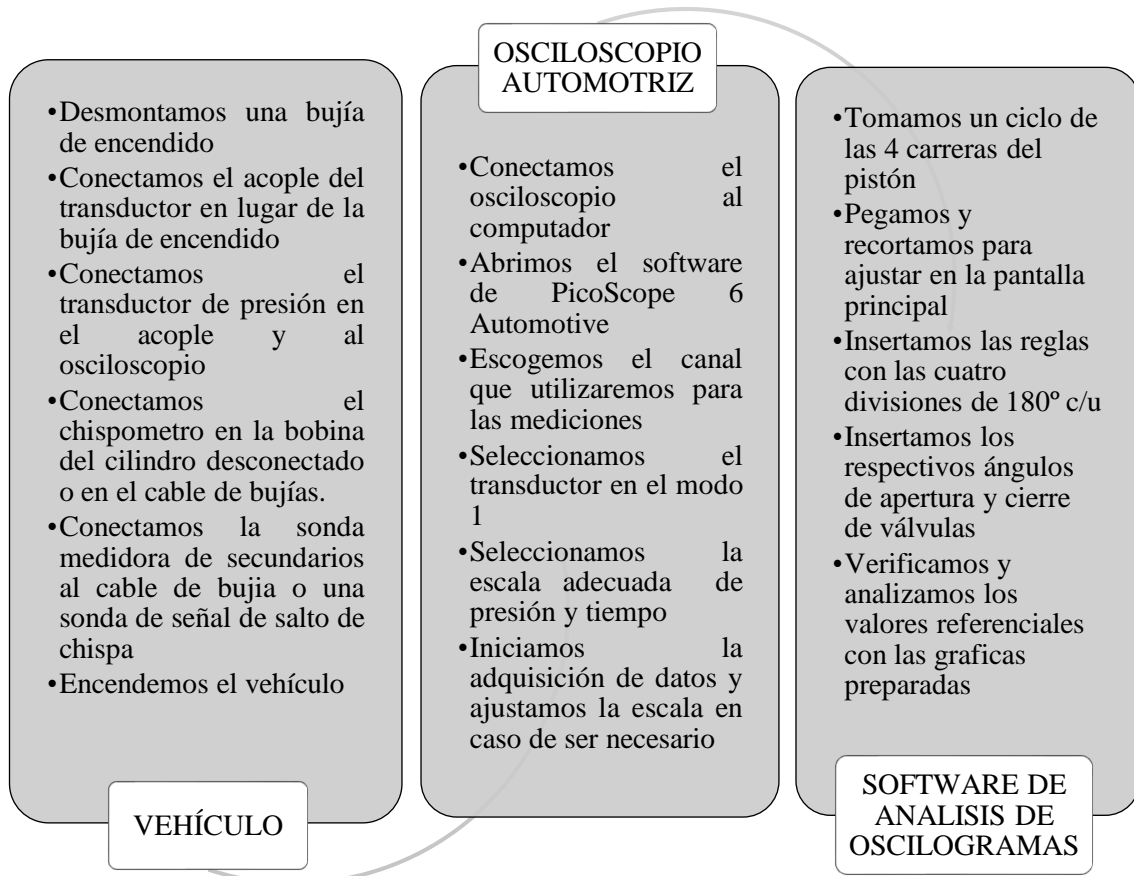
Gráfico 2-3: Procedimientos para realizar las mediciones de presión dentro del cilindro.
