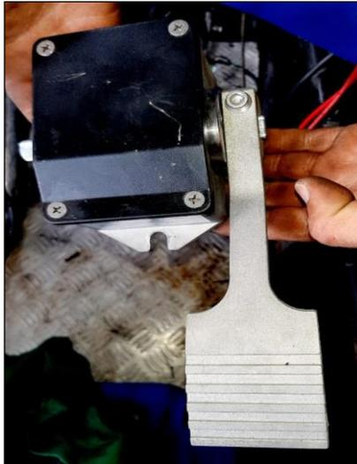
**Figura 12-3:** Pedal electrónico
