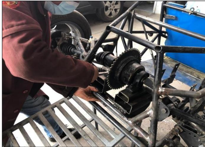
**Figura 4-3:** Construcción de la base del diferencial
