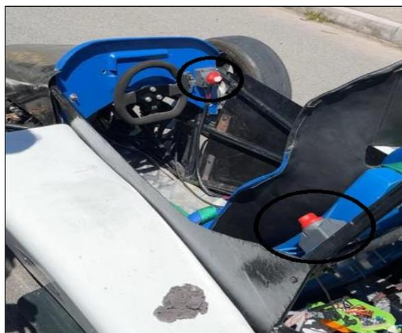
**Figura 17-3:** Ubicación de botones de corte de energía
