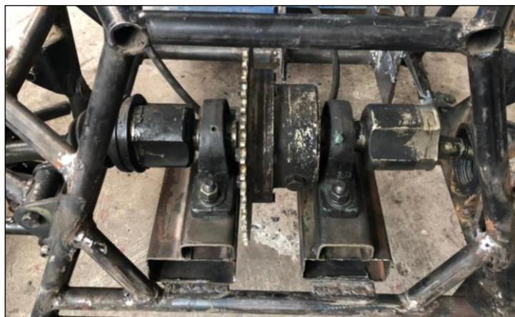
**Figura 5-3:** Montaje del diferencial
