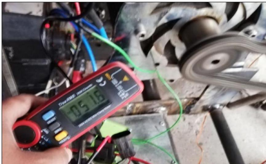
**Figura 11-4:** Medición a máxima velocidad del motor
