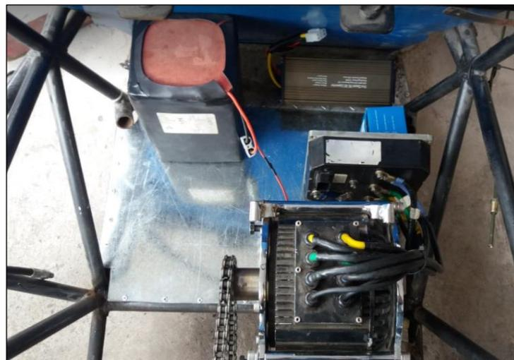
**Figura 3-4:** Instalación del motor eléctrico
