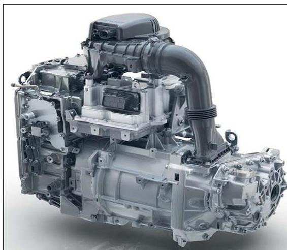
**Figura 7-2:** Motor síncrono de reluctancia combinada Renault ZOE
