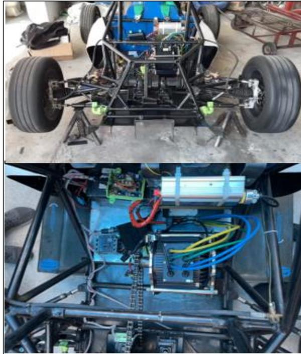
**Figura 12-4:** Montaje final de la tracción eléctrica
