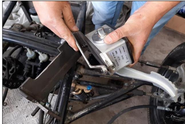
**Figura 6-3:** Ajuste del pedal electrónico a la base
