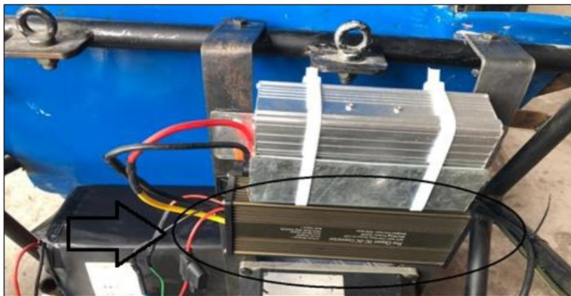
**Figura 13-3:** Regulador reductor de voltaje
