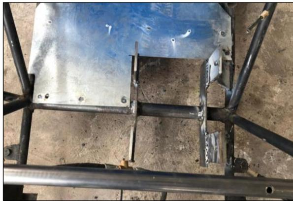
**Figura 3-3:** Construcción de la base del motor
