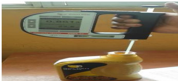
**Figura 21-2:** Toma de muestra de aceite en el equipo
