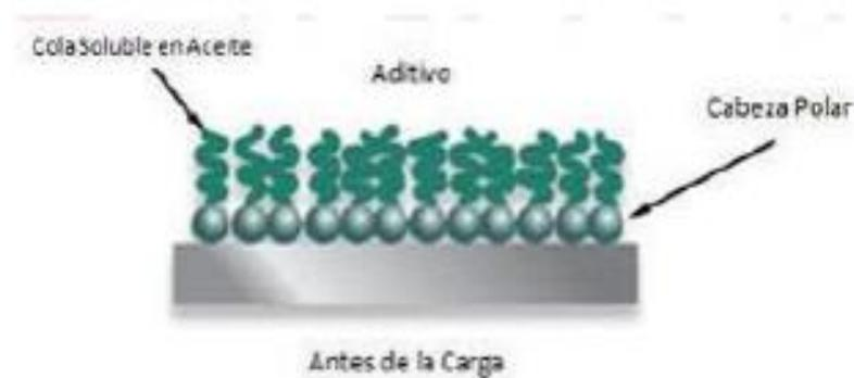
**Figura 5-1:** Esquema de actuación de los aditivos anti-desgaste
