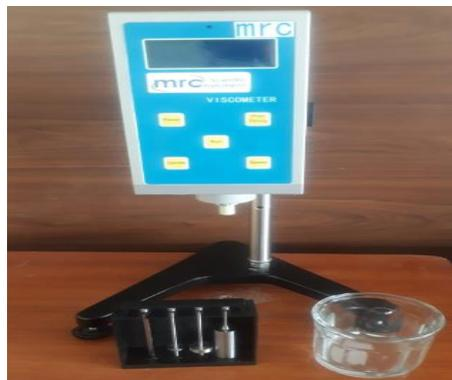
**Figura 5-2:** Equipo viscosímetro
