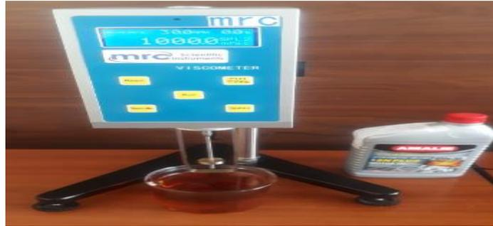
**Figura 19-2:** Muestra de aceite colocada en el equipo
