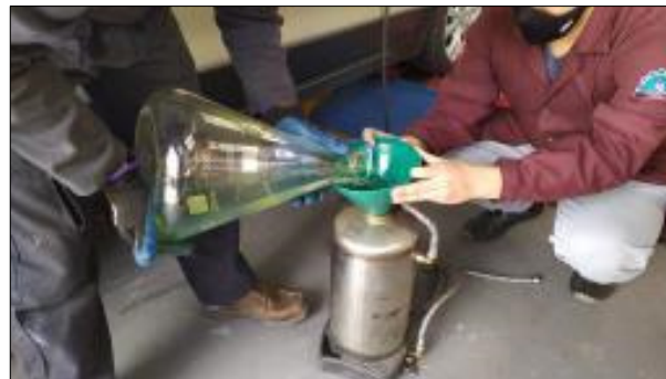
Figura 16-2: Llenando el canister con combustible
