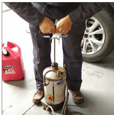
Figura 17-2: Bombeo del canister hasta la presión indicada
