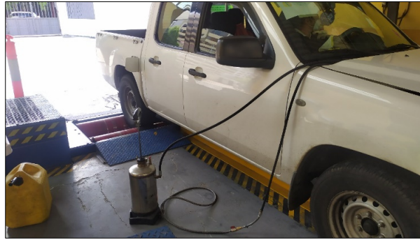
Figura 15-2: Conexión del canister hacia el vehículo
