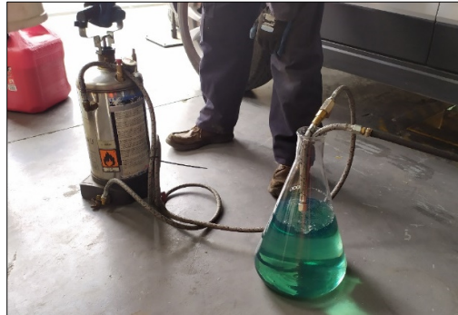
Figura 18-2: Bombeo del canister hasta vaciar en el Erlenmeyer
