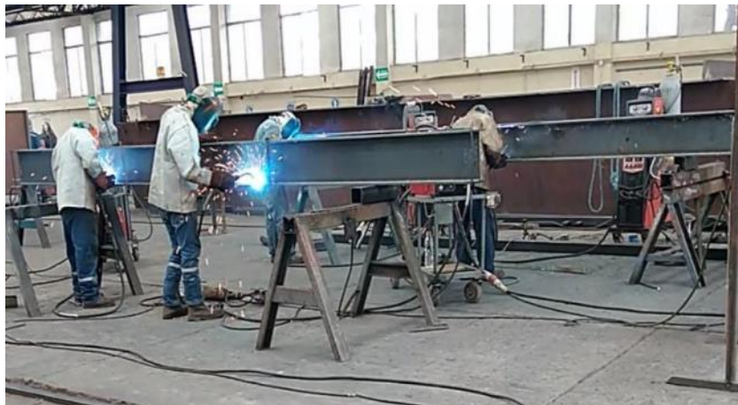
Figura 6-3: Subproceso de soldadura GMAW
