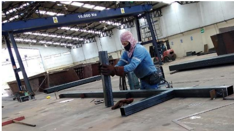
Figura 5-3: Subproceso de armado
