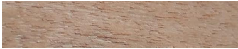
Figura 15-3. Corte radial de Theobroma subincanum Mart.
