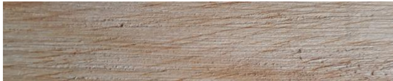
Figura 18-3. Corte tangencial de Virola reidii Little.
