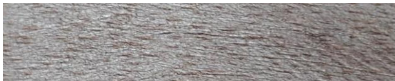
Figura 19-3. Corte radial de Virola reidii Little.
