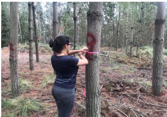
Figura 1-2. Medición del CAP con cinta métrica
